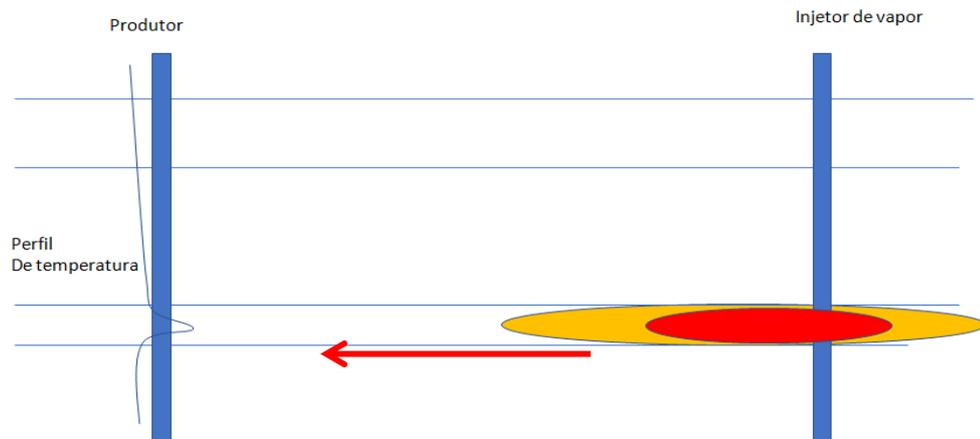
Figura 13–Esquema mostrando o aquecimento do reservatório pela injeção de vapor. A seta indica a direção de fluxo de fluidos.
