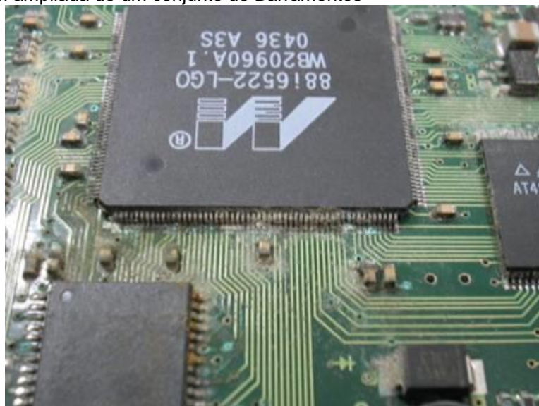
Figura 14: Imagem ampliada de um conjunto de Barramentos
