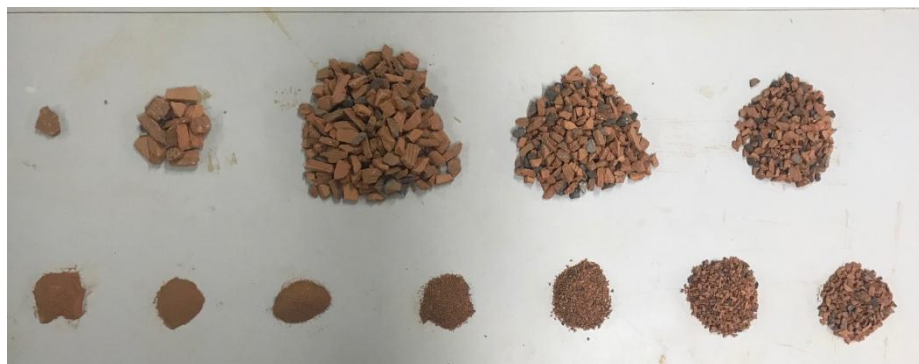
Figura 6 – RCD triturado e separado granulometricamente. Fonte: O autor (2018).
