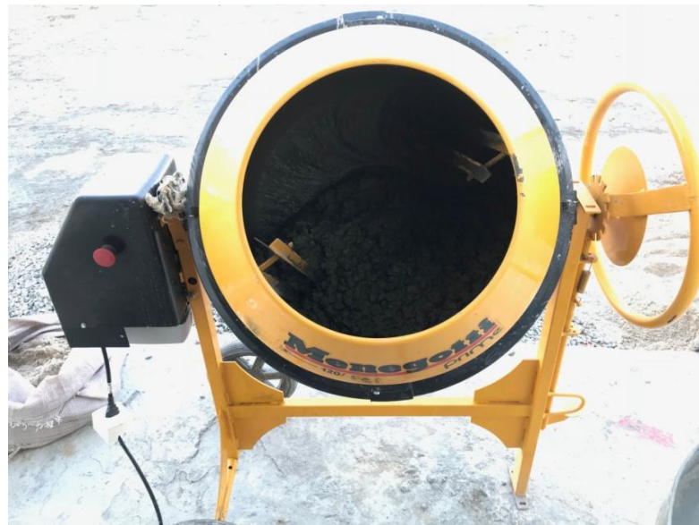
Figura 7 - Betoneira e preparo do concreto. Fonte: O autor (2018).
