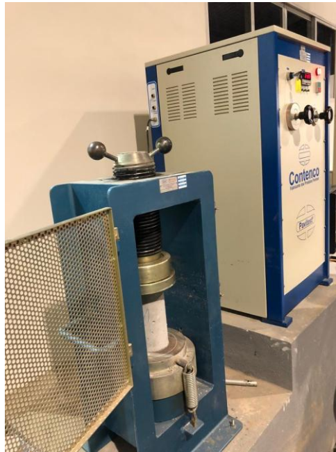
Figura 11 - Rompimento dos corpos de prova. Fonte: O autor (2018).
