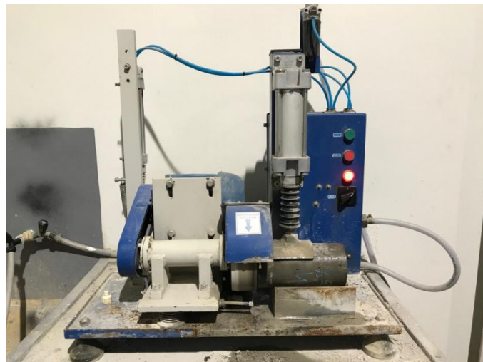
Figura 10 - Retificação do corpo de prova. Fonte: O autor (2108).
