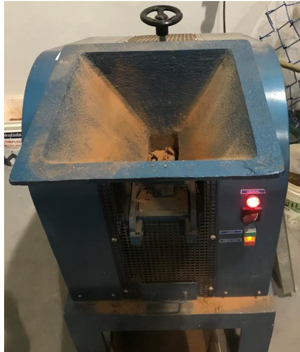
Figura 4 - Britador de mandíbula utilizado para triturar o material separado. Fonte: O autor (2018).
