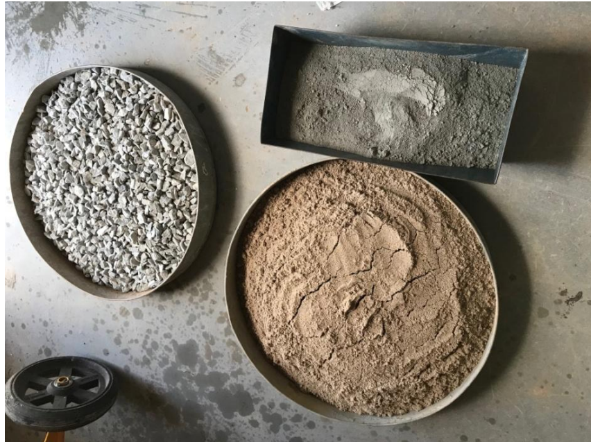
Figura 2 - Materiais para confecção do concreto convencional. Fonte: O autor (2018).
