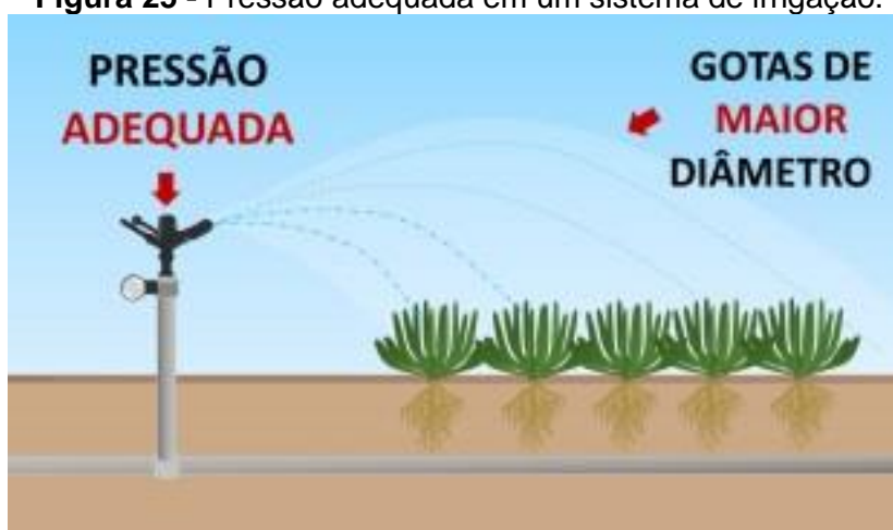
Figura 25 - Pressão adequada em um sistema de irrigação.
