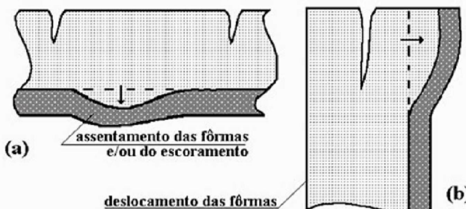
Figura 10: Ilustração de possíveis deformações nas fôrmas.
