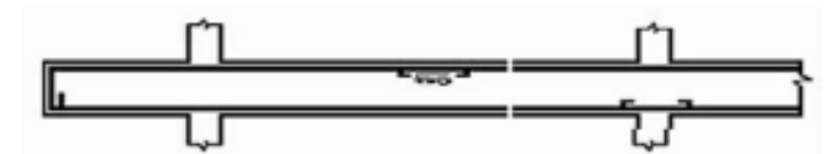
Figura 7: Por compressão, consequência da insuficiência de armadura de compressão.
