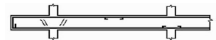
Figura 8: Por cisalhamento, consequência da insuficiência de estribo
