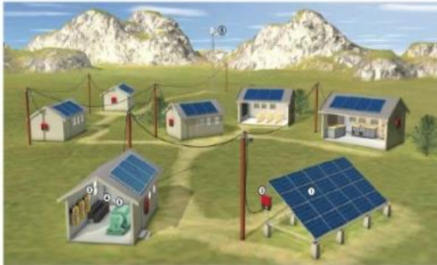
**Figura 9:** Sistema isolado em mini rede.
