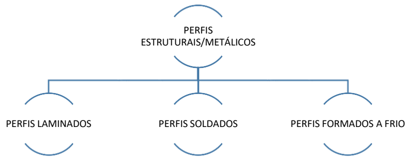
Figura 4 - Hierarquia perfis estruturais.
