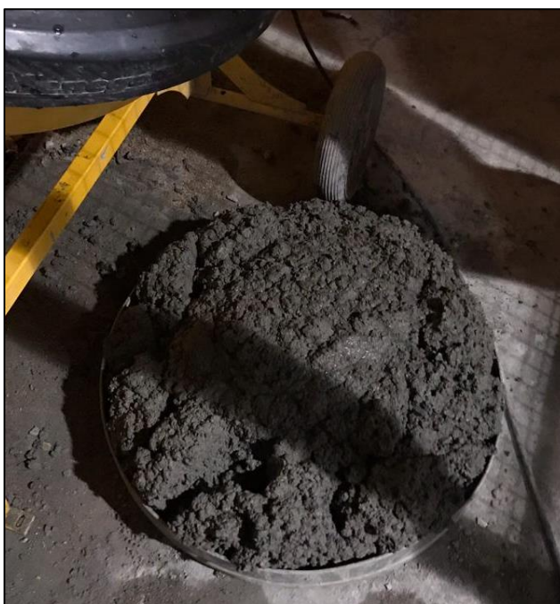
Figura 38 - Concreto pronto para moldar os corpos de prova do tipo fêmea
