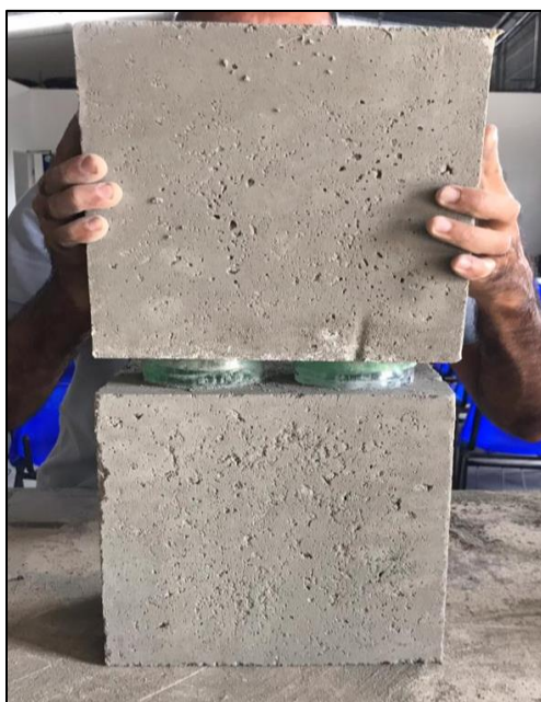
Figura 48 – Tijolos recicláveis sendo previamente encaixados
