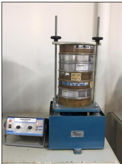
Figura 15 – Peneiras posicionadas na peneira vibratória de acordo com a ordem estabelecida pela Norma de Desempenho.
