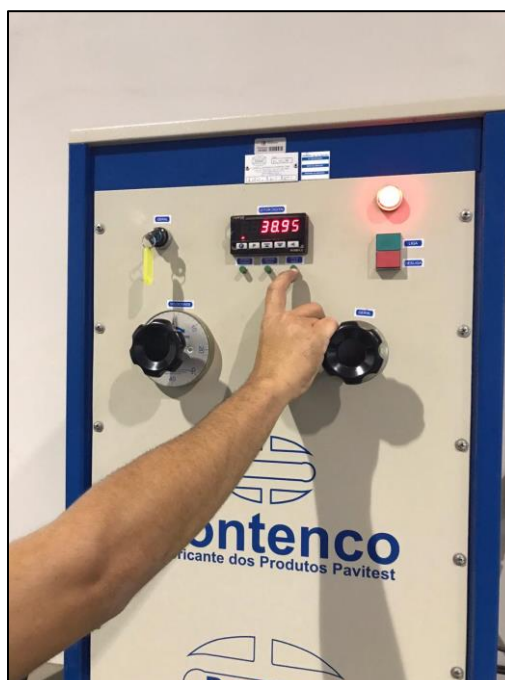
Figura 55 – Representação da resistência à compressão do Bloco 3/1 do tipo fêmea em toneladas força
