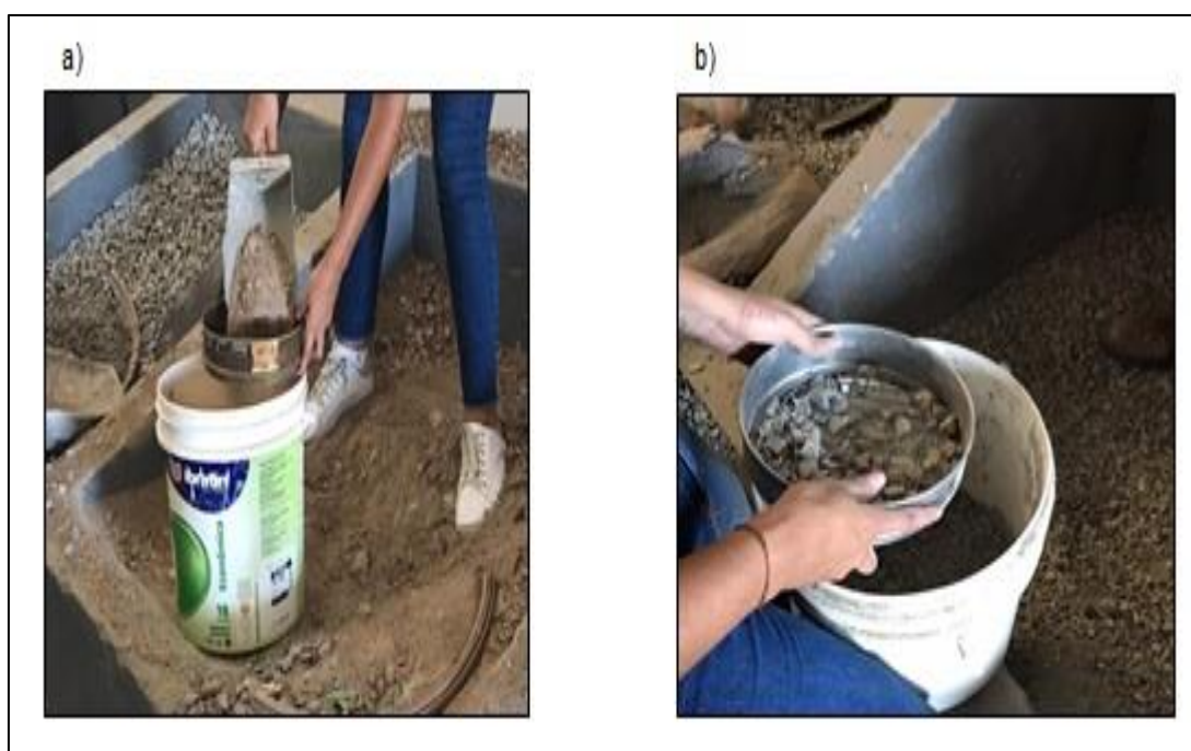
Figura 35 – (a) Peneiramento da areia média com o uso da sua respectiva peneira, (b) Peneiramento da brita 0 com o uso das sua respectiva peneira
