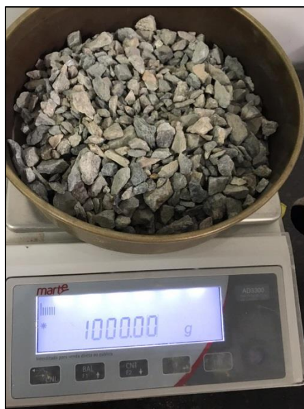
Figura 17 – Pesagem da brita 0 na balança analítica
