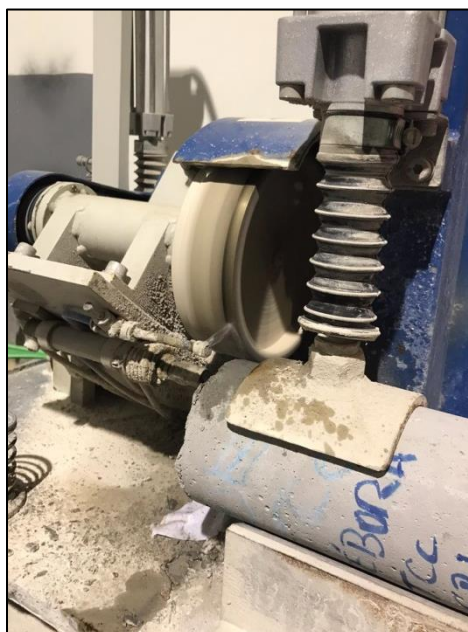
Figura 51 – Retificação do corpo de prova cilíndrico
