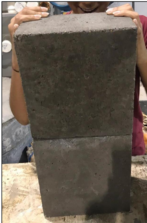
Figura 57 – Tijolos sustentáveis, macho e fêmea, encaixados.
