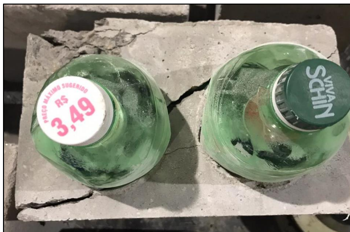
Figura 54 – Ruptura cisalhante no tijolo reciclável de PET
