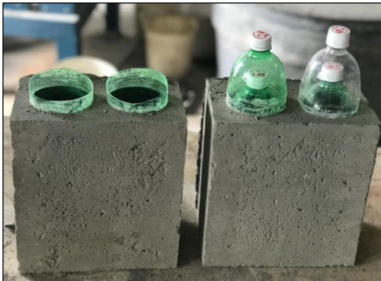
Figura 47– Tijolos de Garrafa PET desmoldados
