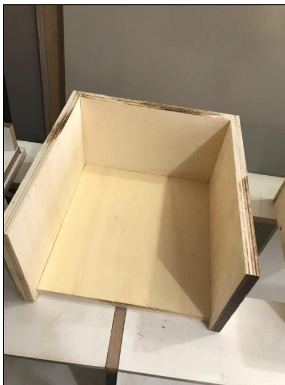
Figura 34 - Início da moldagem das fôrmas prismáticas
