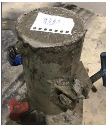
Figura 45 – Fôrma metálica com concreto moldado
