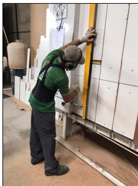
Figura 32 - Execução dos cortes para a confecção das fôrmas prismáticas do tijolo reciclável de garrafa PET.
