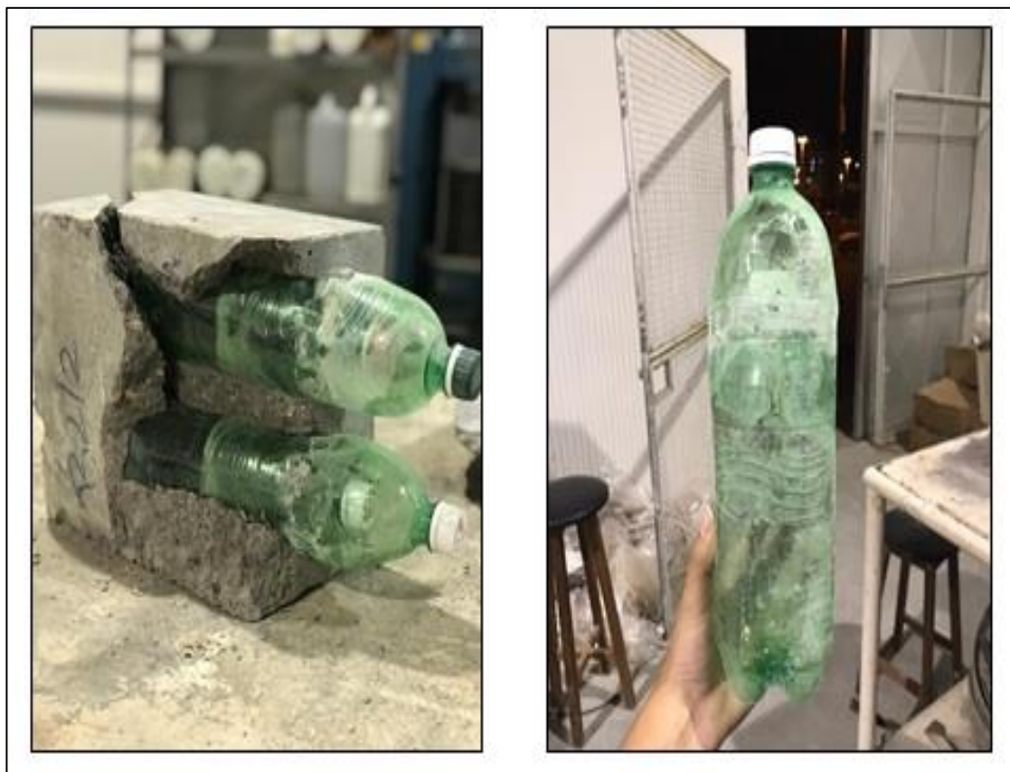
Figura 56 – Garrafas PET intactas depois do recebimento de cargas
