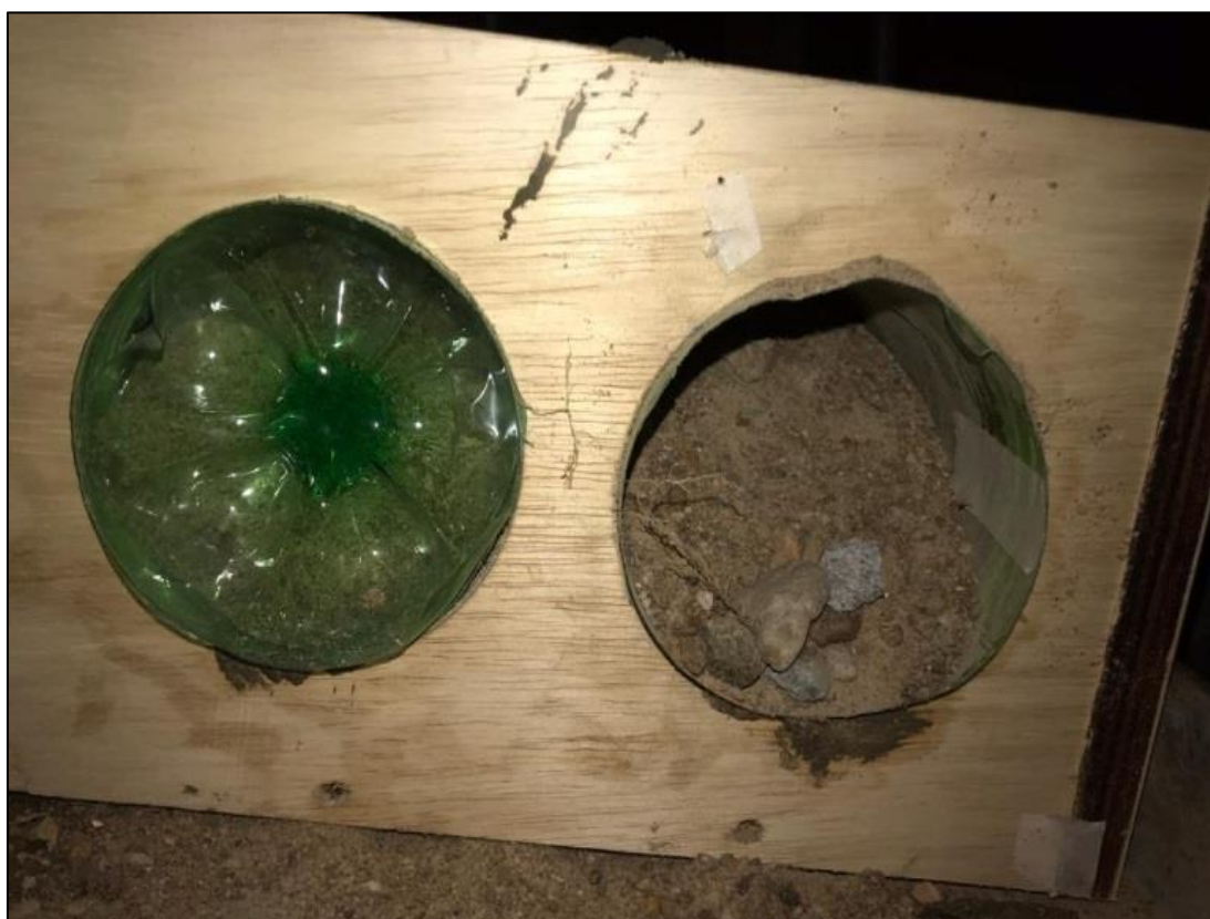
Figura 43 – Tijolos do tipo fêmea preenchidos no interior das garrafas com areia, as quais foram fechadas com o fundo das mesmas
