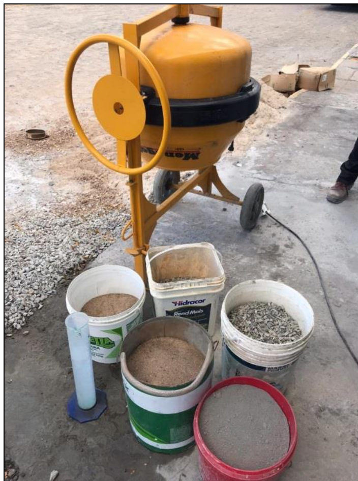
Figura 36 - Materiais separados com as quantidades calculadas prontas para serem misturados no aparelho
