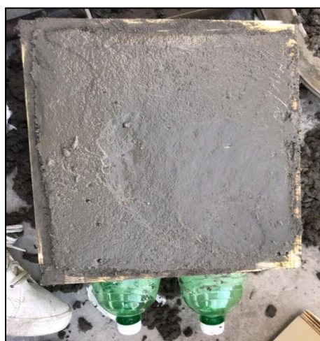
Figura 41 – Finalização da última camada de concreto do tijolo
