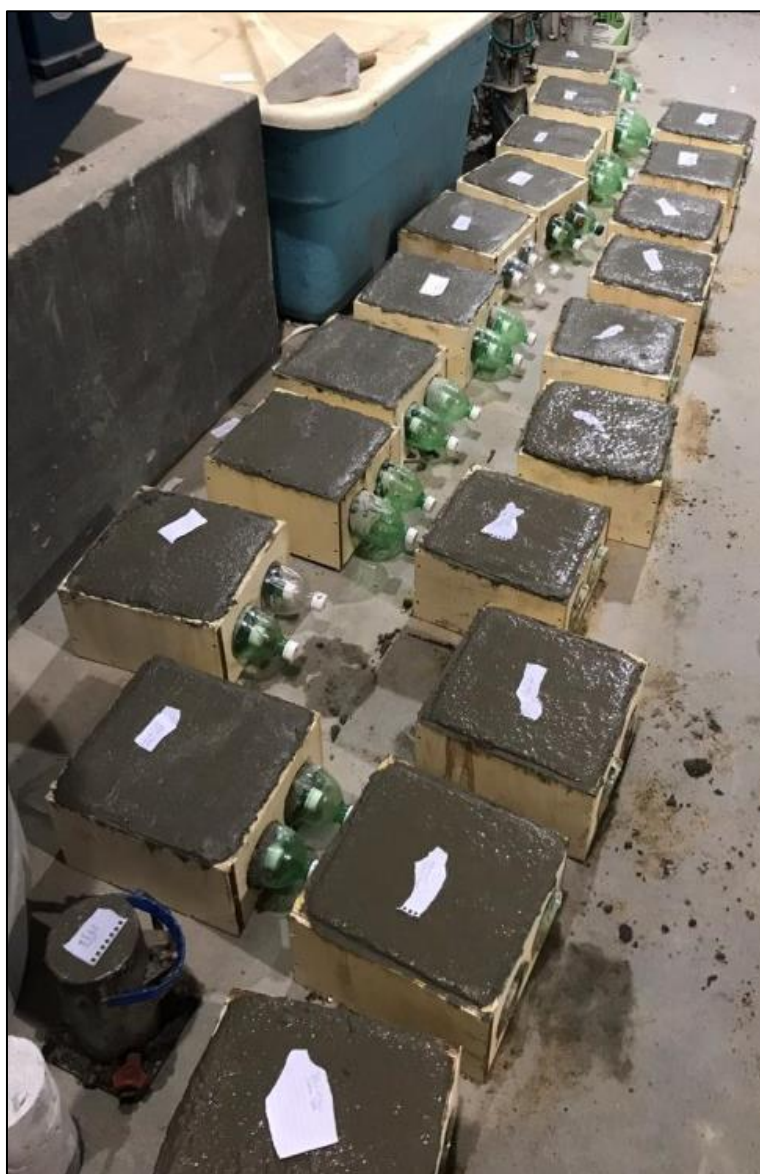
Figura 44 – Moldes identificados e colocados em local plano, de acordo com a norma, cumprindo a cura inicial
