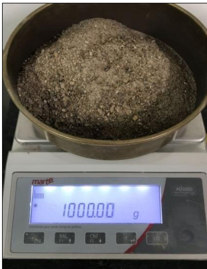
Figura 14 – 1000g de areia média colhida e pesada na balança digital
