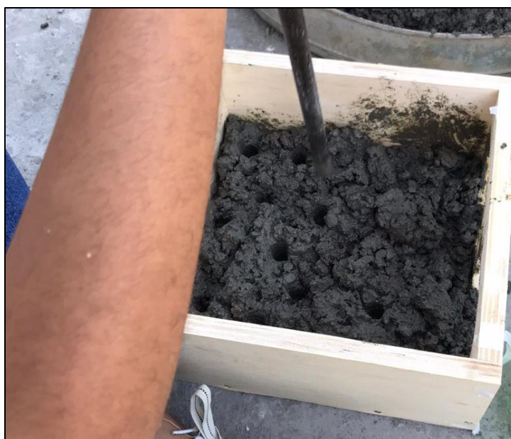
Figura 39 – Realização do adensamento na primeira camada de concreto na fôrma de madeira
