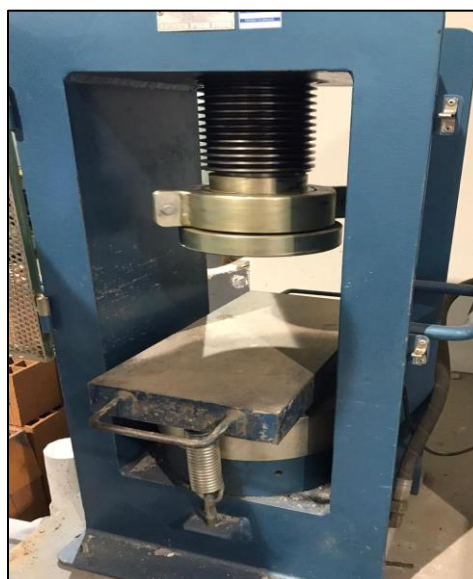
Figura 24 – Máquina ajustada e com o prato inferior colocado para a realização do ensaio
