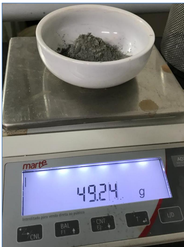
Figura 27 – Valor da massa retida na peneira de nº 200 após o peneiramento
