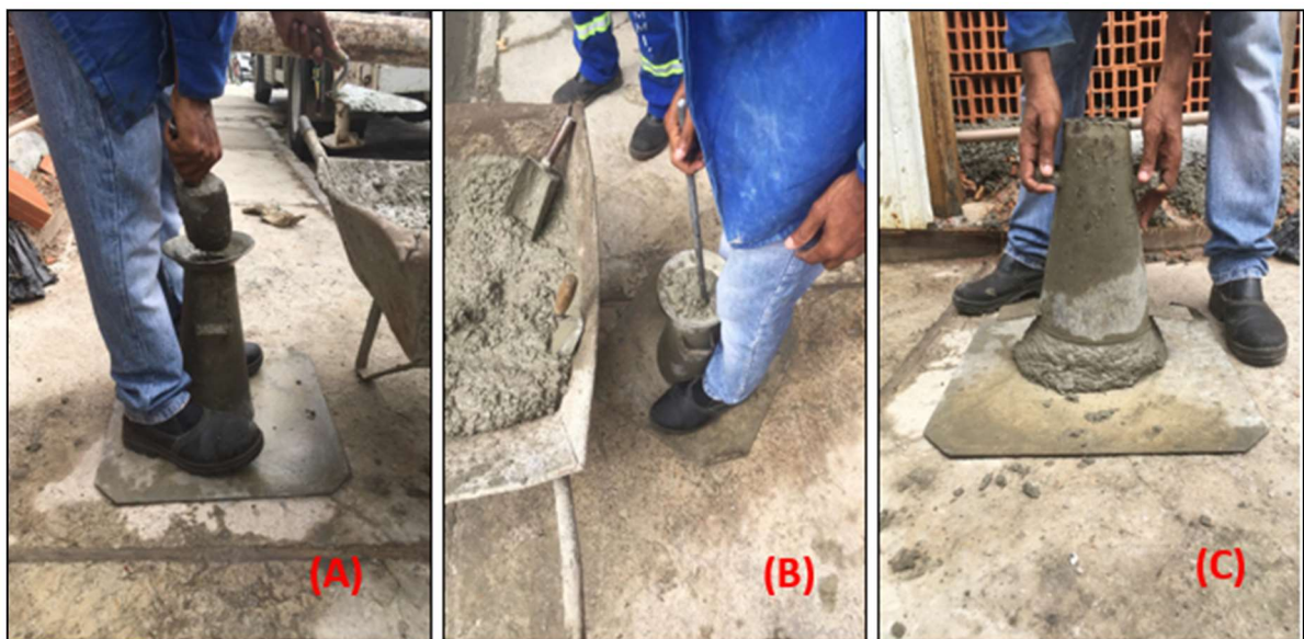
Figura 21 – (A) Preenchimento do molde. (B) Adensamento das camadas. (C) Retirada do molde
