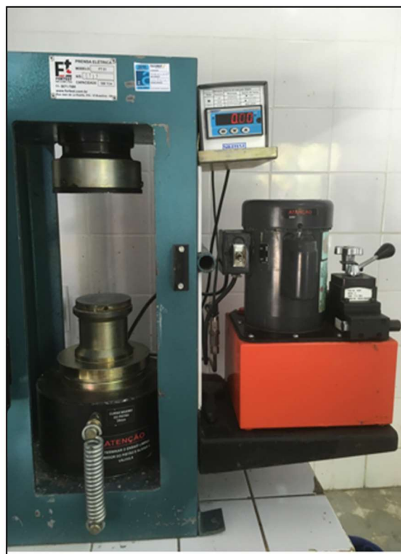
Figura 17 – Prensa Hidráulica utilizada no ensaio de compressão axial.
