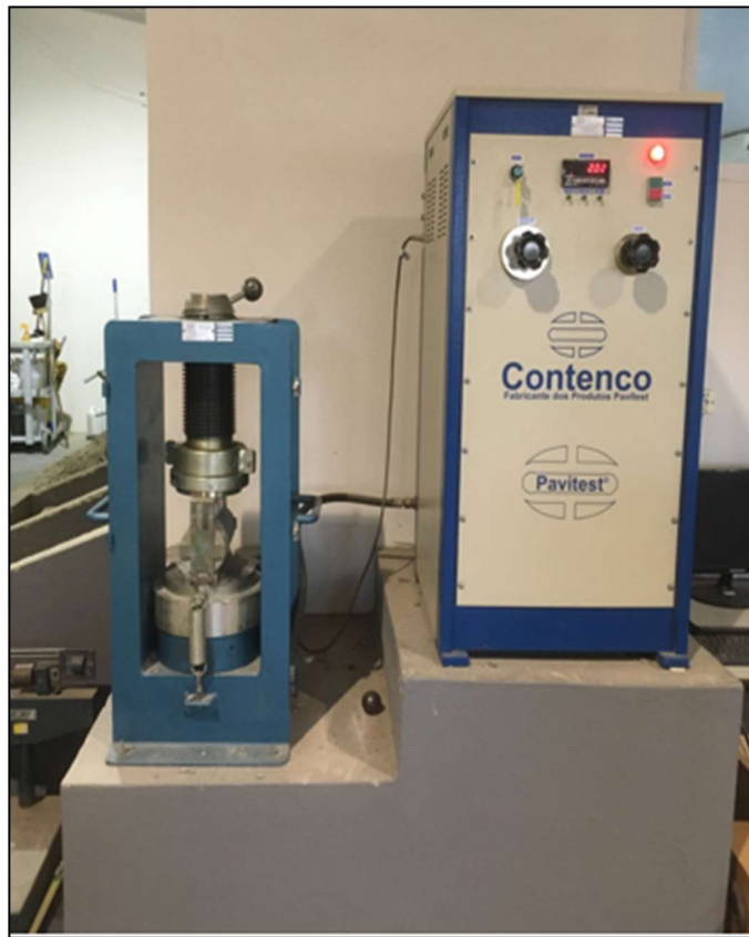
Figura 19 – Prensa Hidráulica utilizada no ensaio de tração por compressão diametral.
