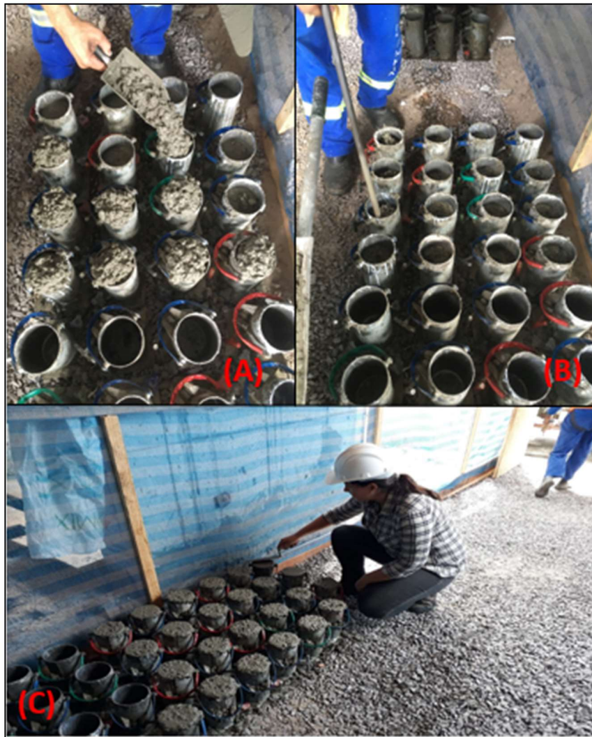
Figura 23 – (A) Preenchimento do molde. (B) Adensamento. (C) Acabamento da face.
