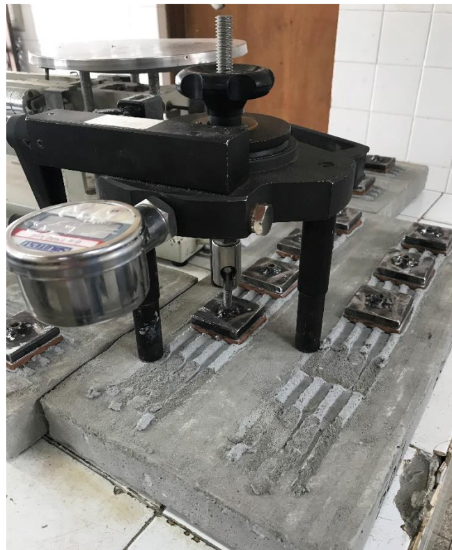
Figura 25: Ensaio de arrancamento.
