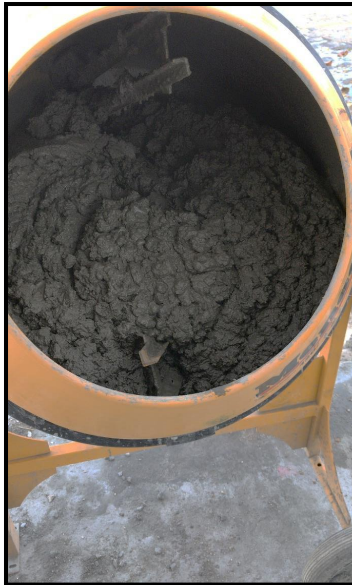
Figura 14: Concreto homogêneo utilizado no substrato-padrão.
