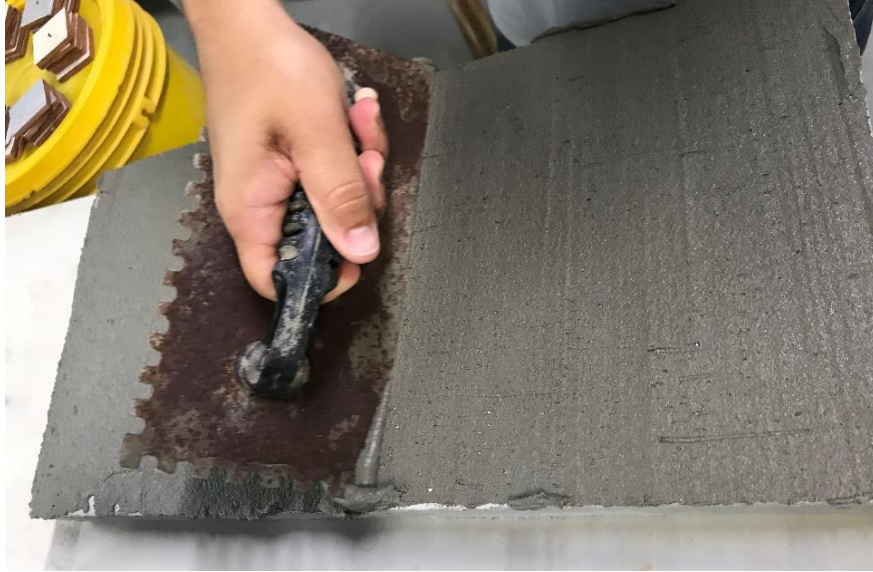
Figura 17: Aplicação da argamassa no substrato-padrão.
