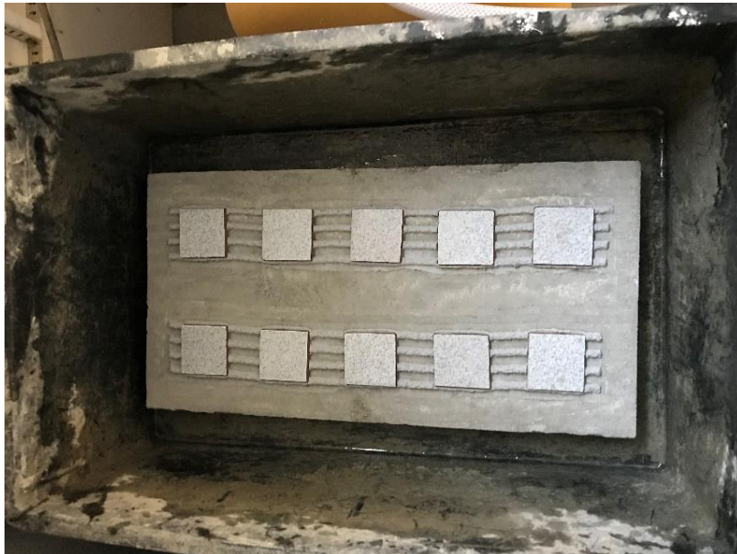
Figura 23: Cura da argamassa com imersão em água.
