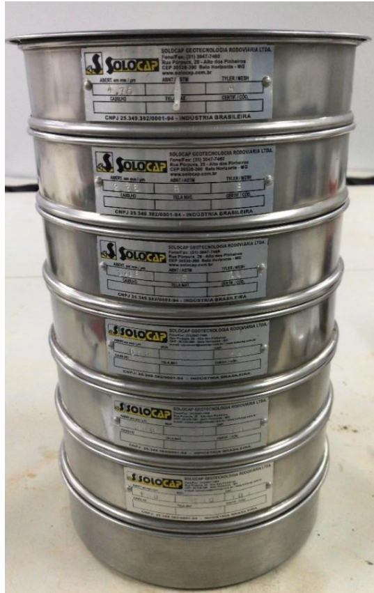
Figura 6: Conjunto de peneira da série normal.
