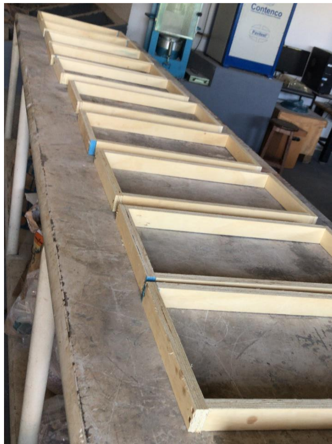
Figura 13: Fôrma para execução do substrato-padrão.
