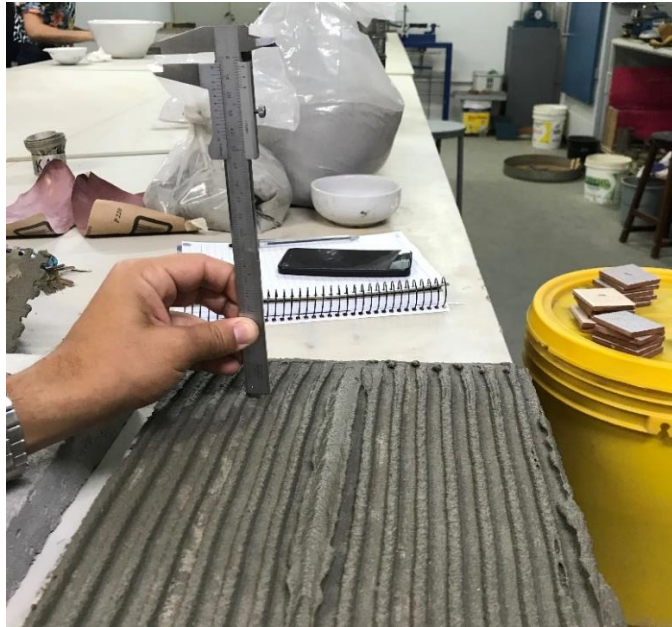
Figura 19: Verificação da altura dos cordões com auxílio do paquímetro.
