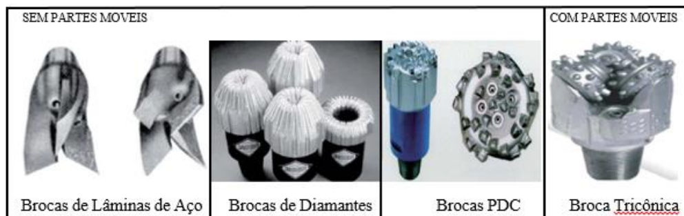
Figura 3: Brocas de perfuração. Fonte: Adaptado (SANTANA, 2010).
