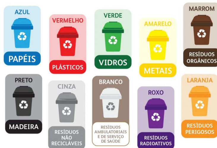
Figura 15: Código de cores conforme a Resolução CONAMA N° 275/01. Fonte: Resolução CONAMA N° 275/01.
