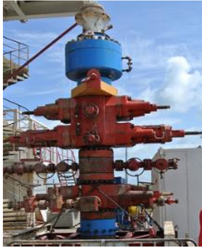
Figura 10: Blowout Preventer (BOP). Fonte: (PEEK, 2013).
