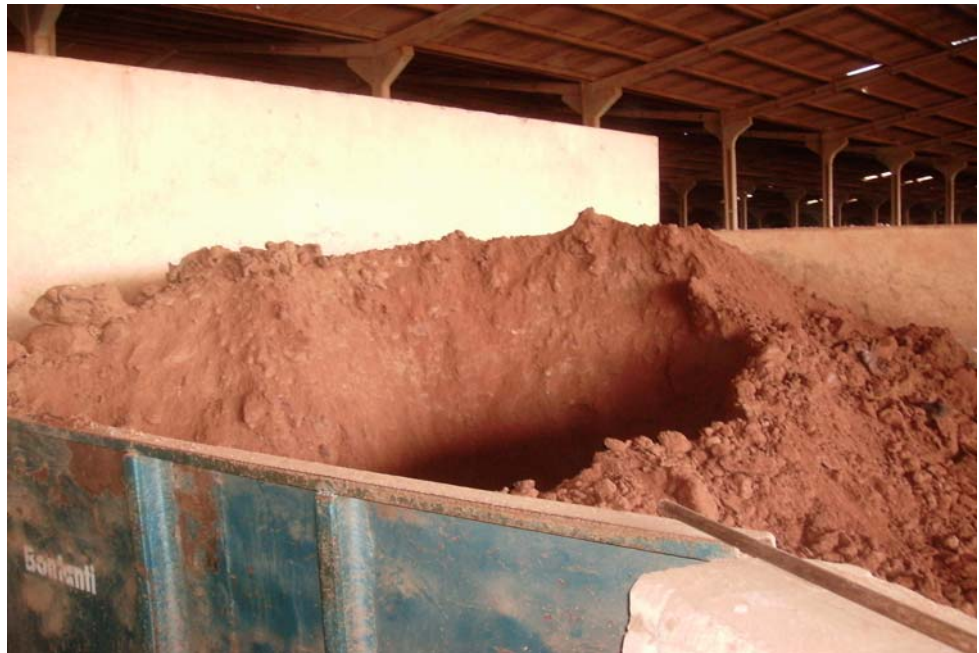
Caixão alimentador (silo Dosador1)
