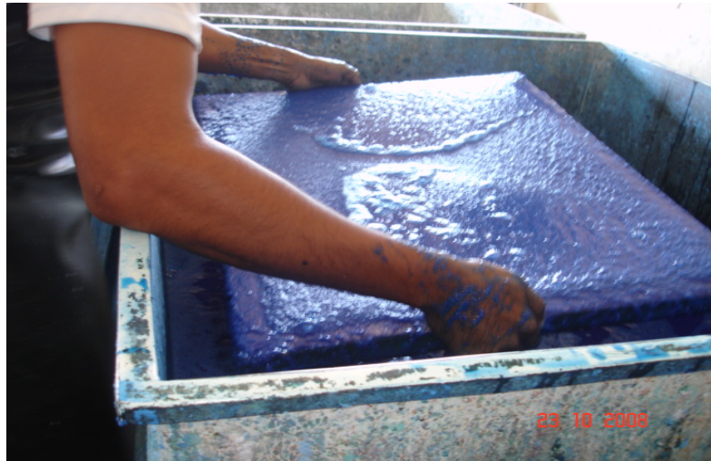
Tanque de armazenamento e produção de folhas de papeis reciclados com telas. Foto: Amanda L. S. Bastos
