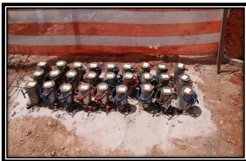
FIGURA 07. Corpos de prova moldados “in loco”.
