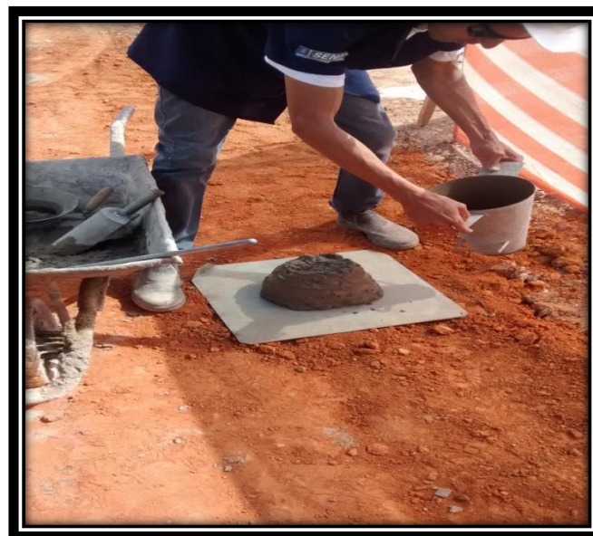
FIGURA 06. Corpo de Prova Desmoldado
