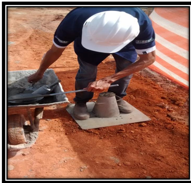
FIGURA 05. Metodologia de enchimento do molde do Slump Teste
