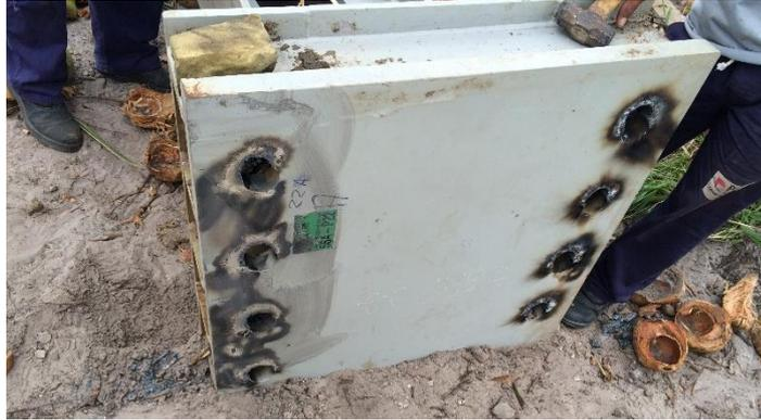
**Figura 06 – Alongamento na furação de base para ajuste de eixo**
