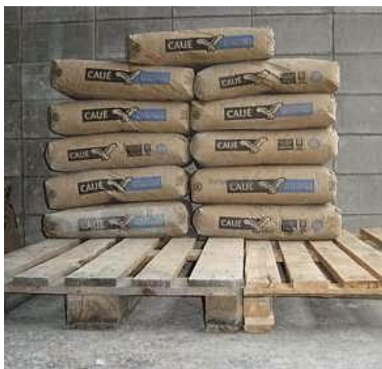
Figura 2: Armazenamento do cimento
