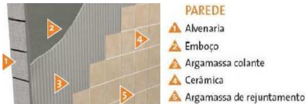
Figura 2. Esquema de base para receber revestimento cerâmico
