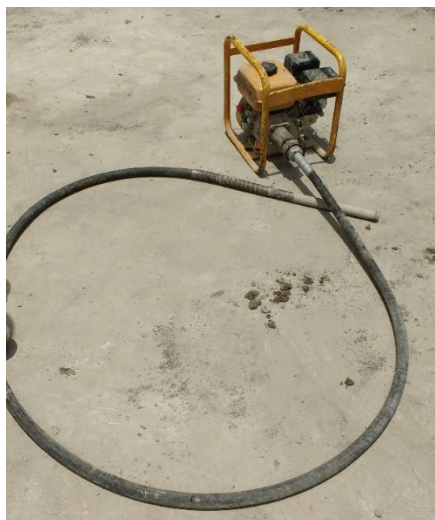
Figura 28 - Conjunto do equipamento para vibração do concreto. Fonte: Acervo do autor, 2015.
