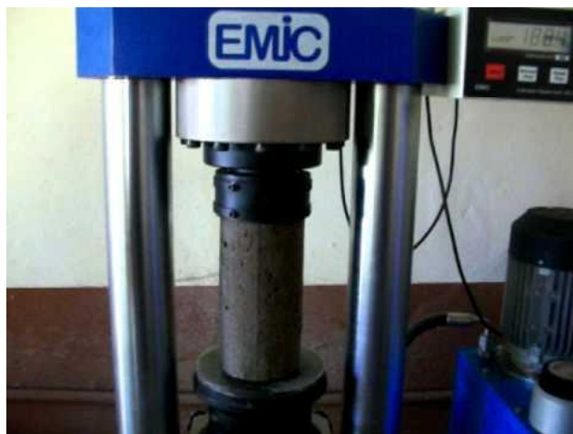
Figura 8- Rompimento de corpo-de-prova, ensaio de compressão. Fonte: http://i.ytimg.com/vi/gDMuj7SsUiM/hqdefault.jpg .
