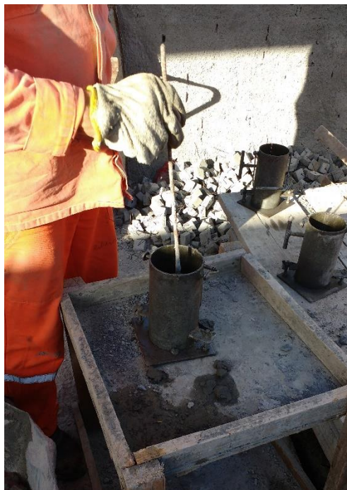
Figura 21 - Corpos de Prova. Fonte: Acervo do autor, 2015.
