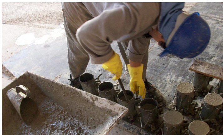
Figura 7 - Moldagem de corpos-de-prova para ensaio de compressão
