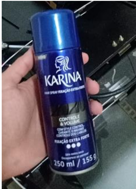
Figura 4 Spray fixador para a mesa aquecida
