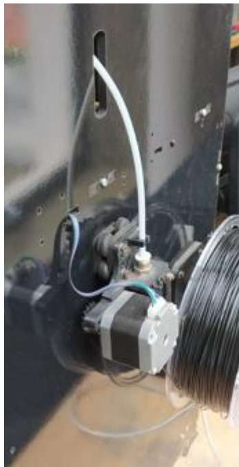
Figura 5 Tubo reparado após o entupimento com rebarbas de filamento
