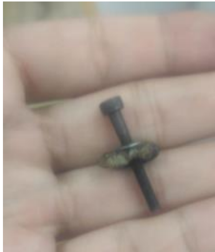
Figura 7 Eixo da base que prende o hotend
