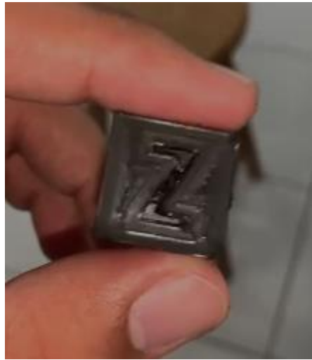
Figura 2 Cubo de calibragem
