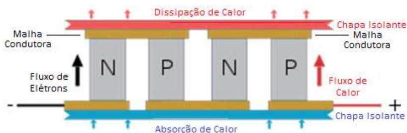
Figura 5 - Esquematização interna de uma Pastilha Peltier
