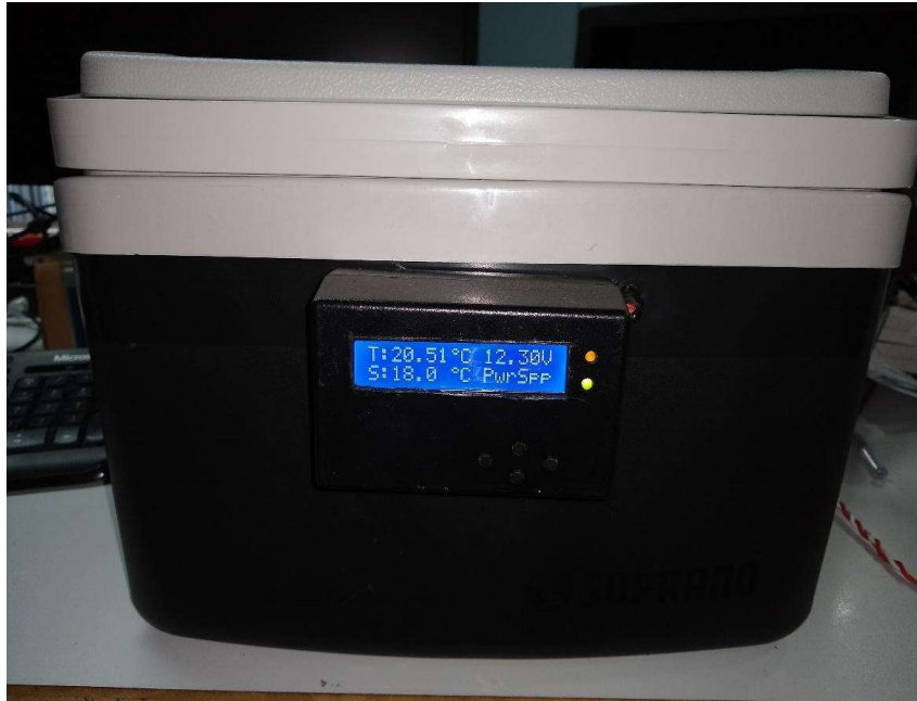
Figura 29 - Montagem Integração Unidade de Refrigeração e Controle
