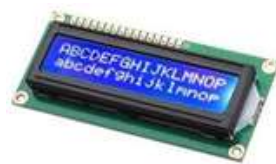
Figura 20 - Display LCD alfanumérico 16 caracteres e 2 linhas.
