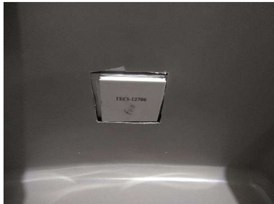
Figura 14 - Parte interna - Instalação Pastilha Peltier
