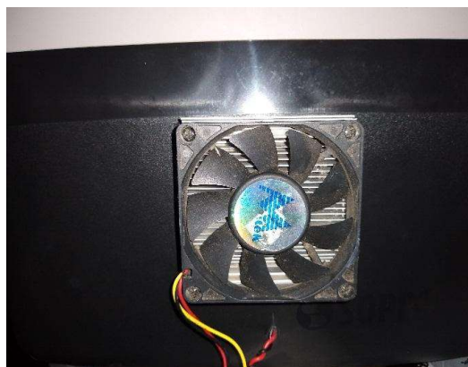
Figura 15 - Parte externa - Instalação Dissipador e Ventoinha
