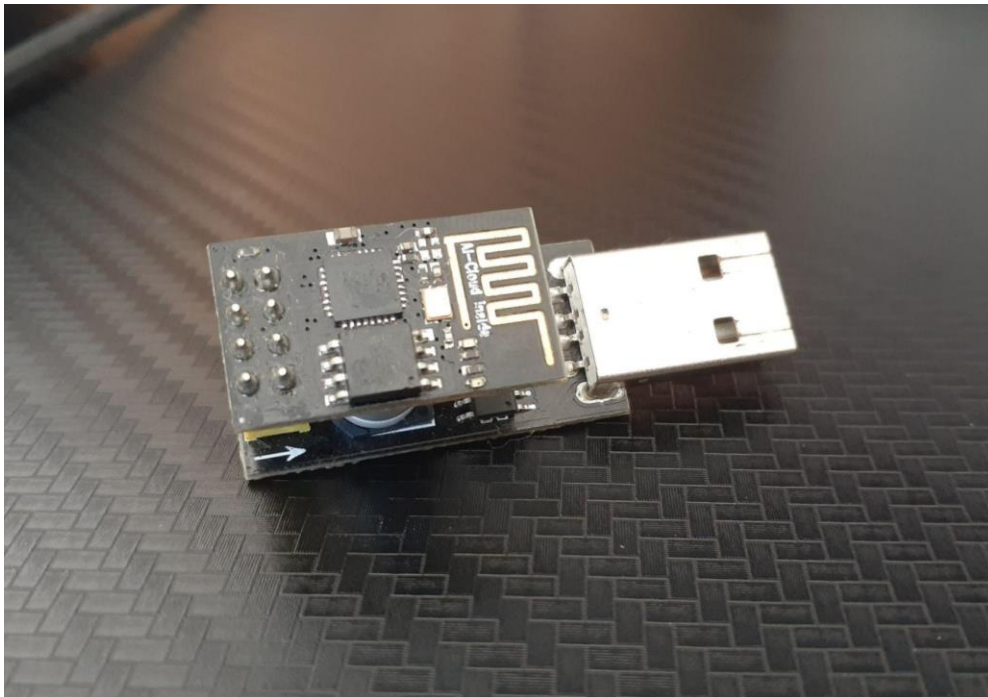
4 Figura 21: ESP8266 com seu gravador USB
