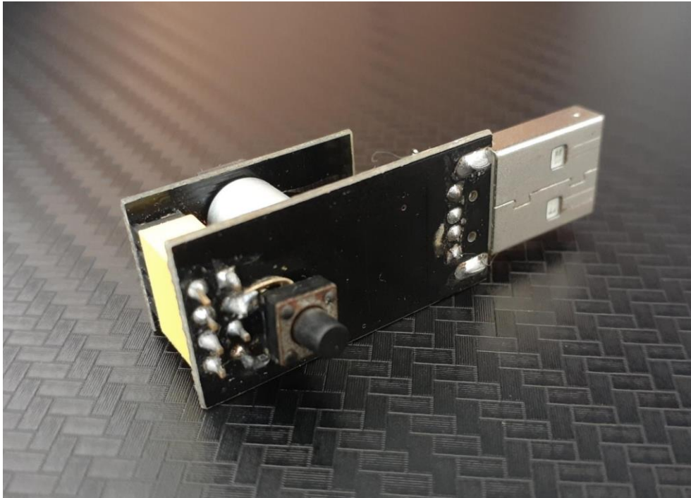
Figura 23: Modificação do gravador USB
