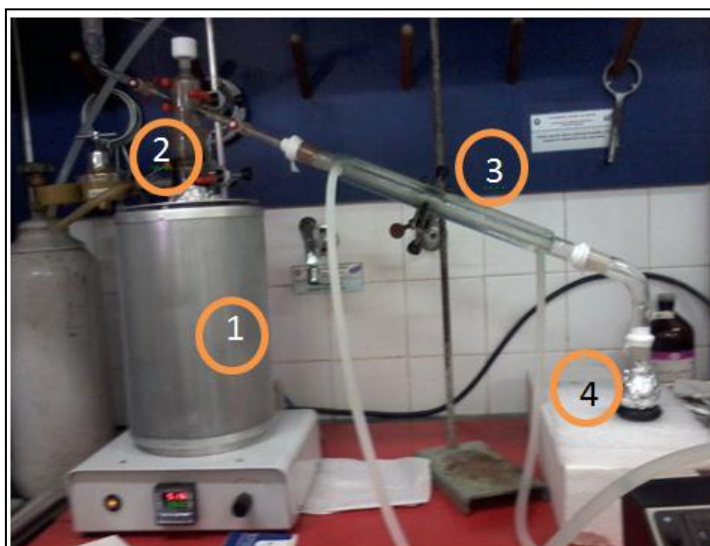
Figura 4.2 - Sistema utilizado para a pirólise composto: forno elétrico (1), Reator (2), condensador (3) e balão para coletar o bio-óleo (4).
