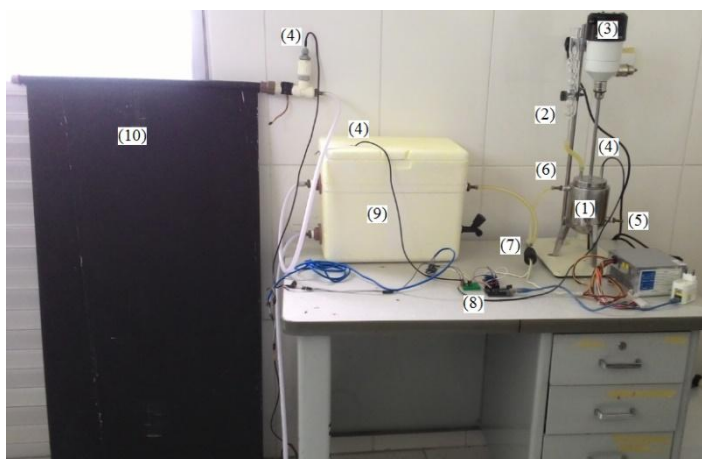
Figura 11: 1 – reator, 2 – condensador, 3 – agitador mecânico, 4 – sensores de temperatura, 5 – agitador mecânico, 5 – entrada de água quente no reator, 6 – saída de água fria no reator, 7 – Arduino, 8 – bomba volumétrica, 9 – reservatório de água, 10 – termossifão.
