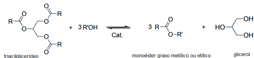
Figura 2: Reação geral de transesterificação para síntese de biodiesel
