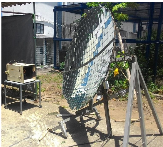
Figura 9: Concentrador solar e forno utilizados na calcinação das amostras da casca de coco.
