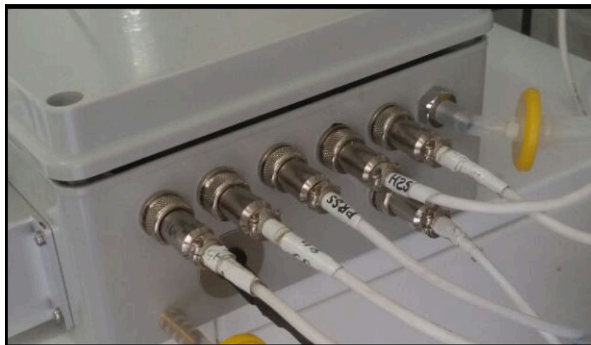
Figura 15: Conexões do analisador de biogás com a CPU-ARDUINO.
