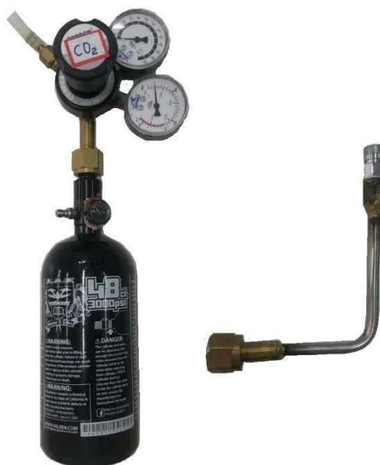
Figura 37: Cilindro adaptado e acessórios usados como garrafa de gás padrão.
