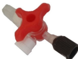
Figura 39: Adaptador para conexão do coletor de biogás.
