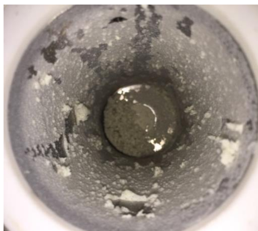
Figura 9 – Sílica obtida no interior da câmara alta pressão. Condição: 150 bar; 40 °C; fluxo de solução 5 mL.min -1 ; vazão de CO 2 15 mL.min -1 ; líquido iônico 0,5% BUT-DOA, razão molar 1:3 TEOS:H 2 O;
