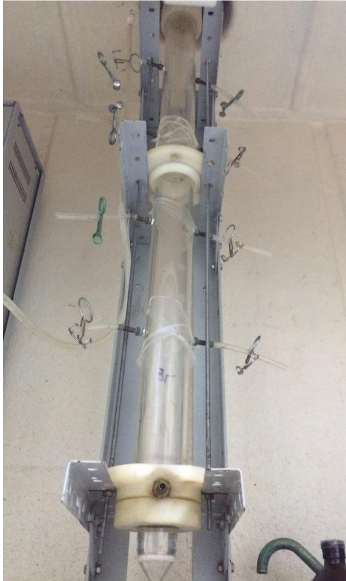
Figura 22: Reator semi-batelada tubular de ozonização
