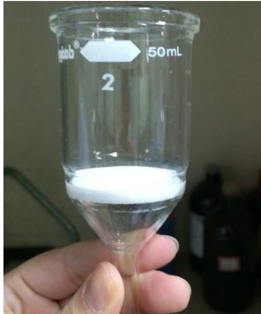
Figura 23: Sistema de vidro sinterizado utilizado para aumento da difusibilidade do gás na coluna do reator
