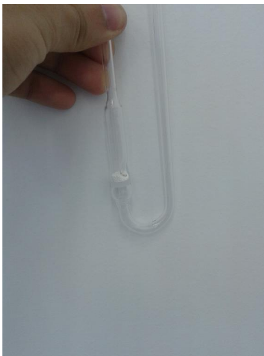
Figura 22: Reator em forma de U com catalisador em forma de pó no leito.
