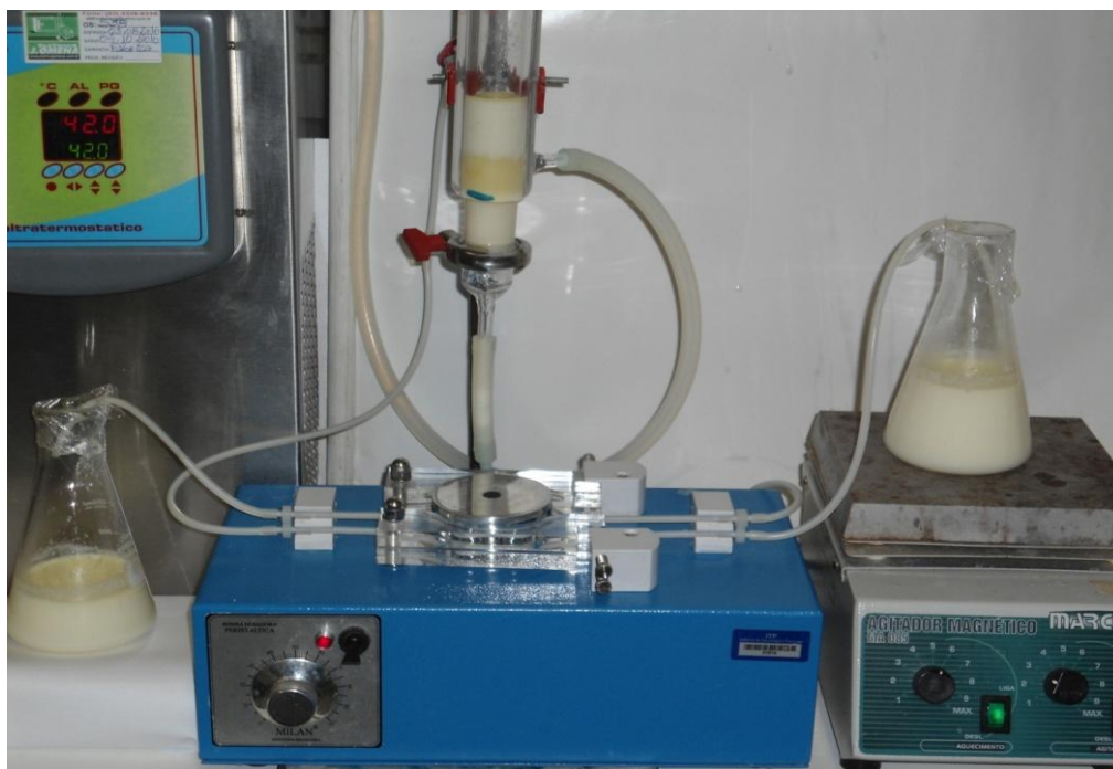
Figura 4.3 - Unidade experimental de remoção e dessorção do colesterol no leite com ampliação de escala.
