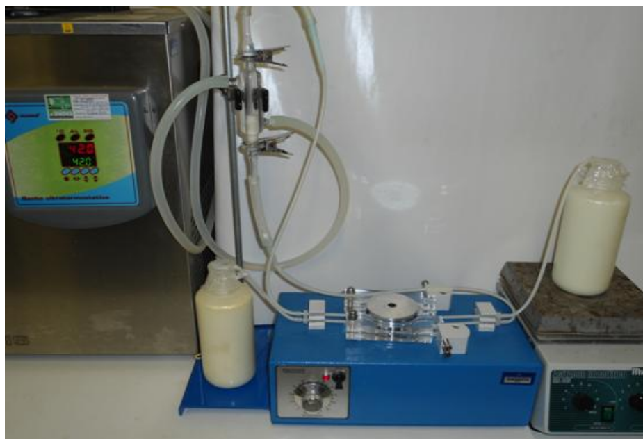
Figura 4.2 - Unidade experimental de remoção e dessorção do colesterol no processo de fluxo contínuo a temperatura controlada.
