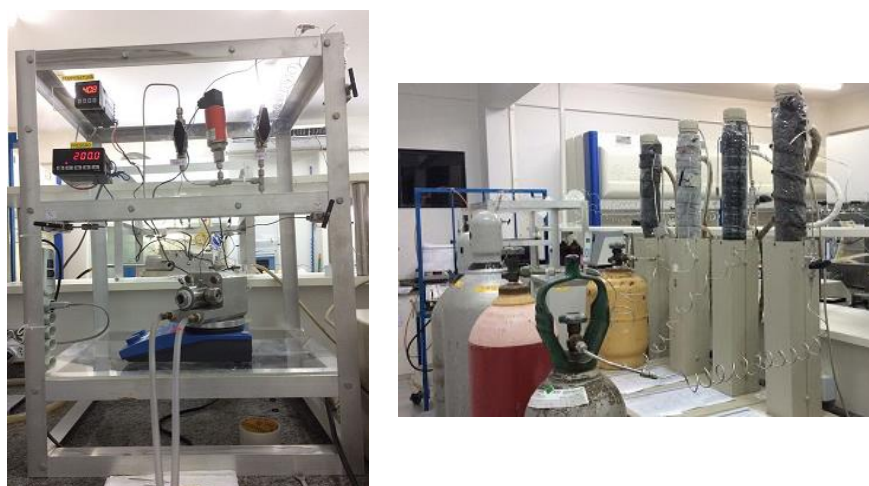
Figura 12: Unidade experimental utilizada para os testes de estabilidade com a MOF-177 e ZIF-8.
