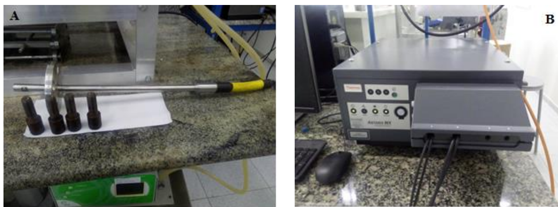
Figura 13: Equipamento utilizado para obtenção dos dados. (A) Sonda do NIR com os parafusos de vedação da unidade, (B) Espectrofotômetro de infravermelho próximo (NIR)
