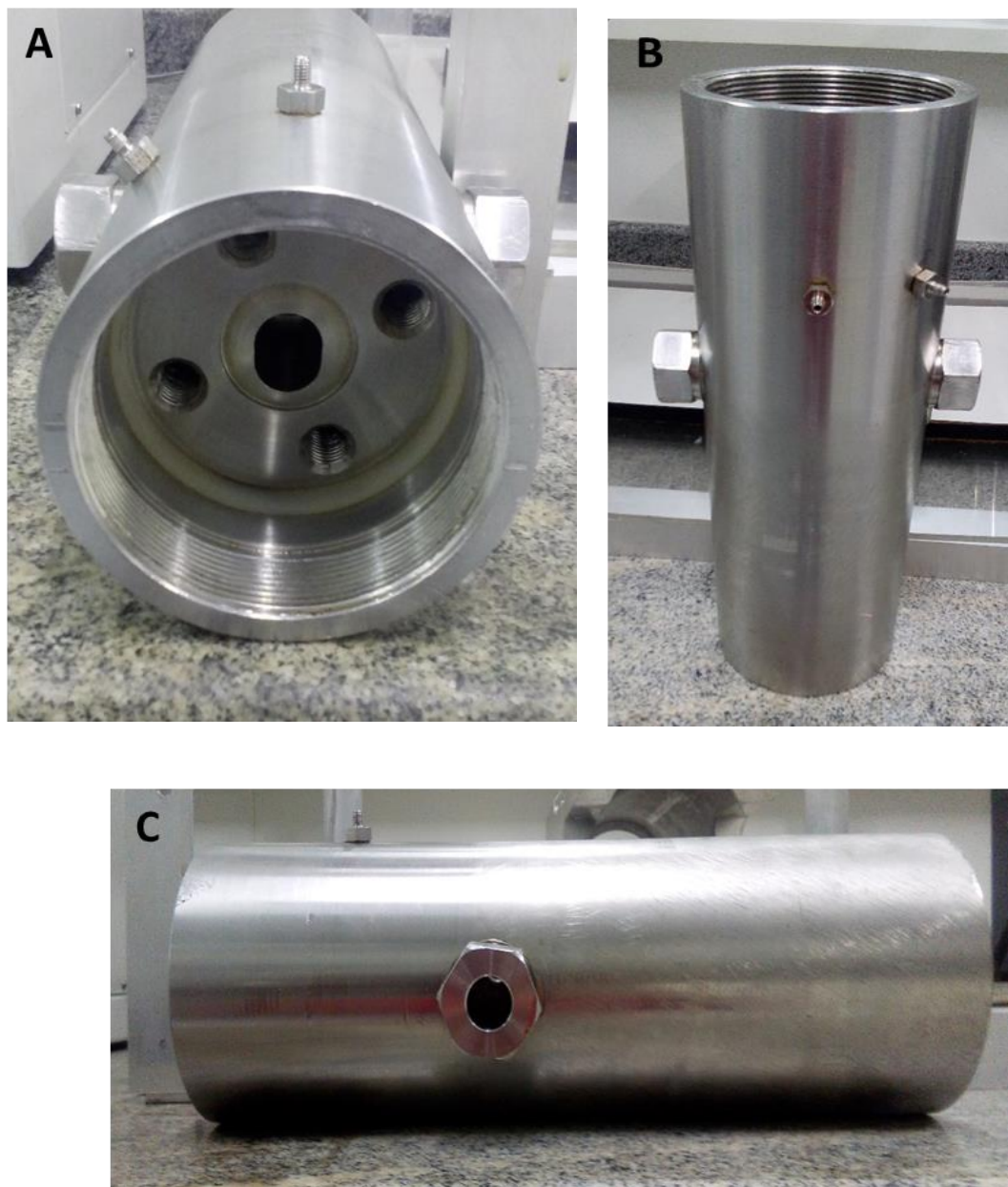
Figura 12: Célula de equilíbrio de volume variável empregada nos experimentos de equilíbrio de fases e precipitação de asfaltenos em condições de alta pressão.. (A) Vista frontal; (B) Vista superior; (C) Vista lateral
