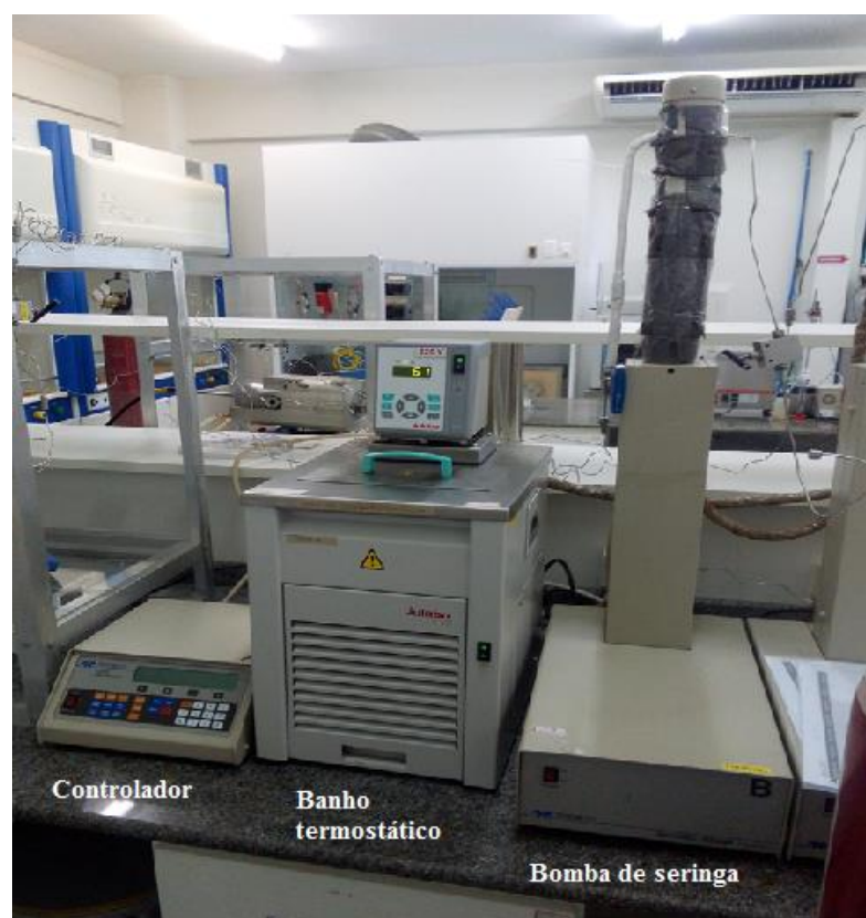
Figura 14: Equipamentos utilizados para a pressurização/alimentação da célula de equilíbrio
