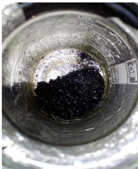
Figura 16: Fração asfáltica extraída do petróleo pela adaptação da norma norma ASTM D6560-00
