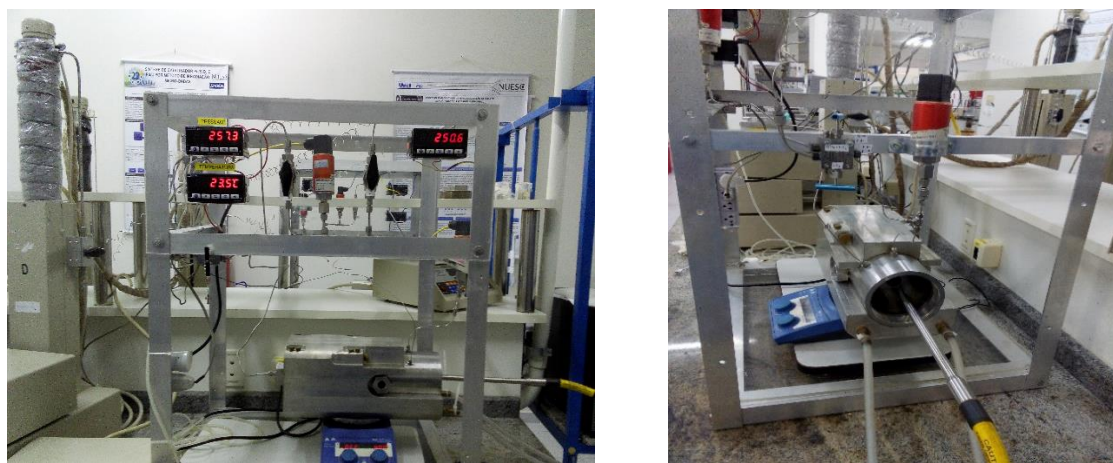
Figura 15: Unidade de equilíbrio de fases e precipitação de asfaltenos a alta pressão: (A) Visão lateral da célula de equilíbrio com a sonda do NIR, (B) Visão frontal da célula de equilíbrio com a sonda acoplada.
