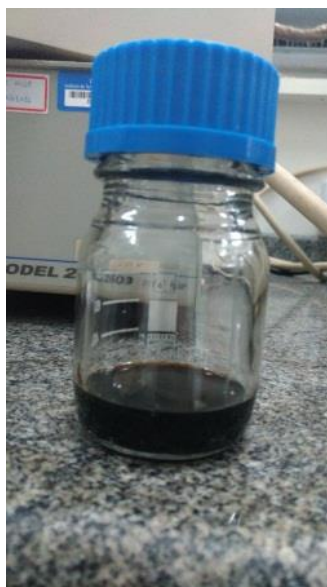
Figura 17: Sistema modelo CeTol na razão 1:1 v/v com a fração asfáltica a 1000 ppm.
