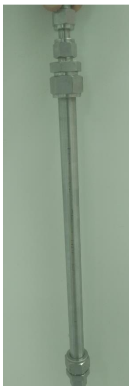
Figura 7: Câmara de secagem (de aço inox com volume útil de 30 mL) utilizada na secagem com CO 2 supercrítico.
