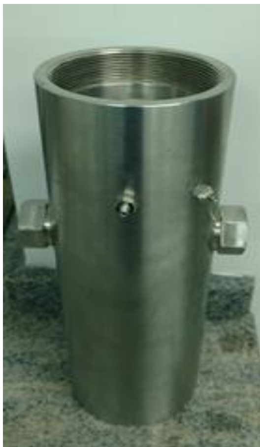
Figura 10: Célula de equilíbrio (de aço inoxidável e volume total de 83 mL) com janelas de safira nas laterais para visualização a olho nu e acoplamento para entrada da sonda NIR.
