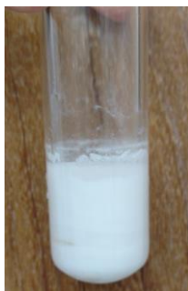
Figura 5: Gel de sílica funcionalizada obtido através da síntese por irradiação micro-ondas.
