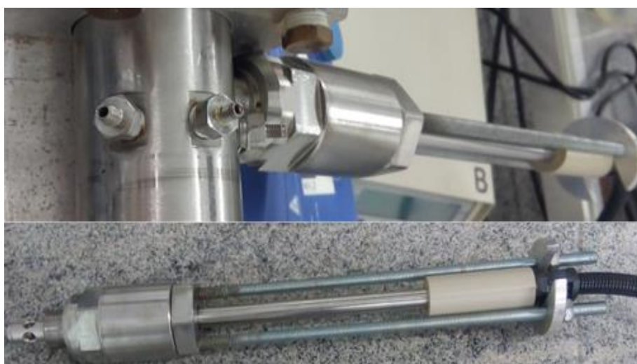
Figura 9. Diagrama esquemático do dispositivo empregado para fixar a sonda NIR na célula de adsorção.
