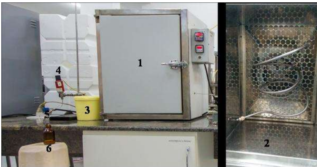
Figura 12: Sistema de transesterificação. 1- Forno, 2- Reator tubular, 3 – Trocador de calor, 4 – Transdutor de pressão, 5 – Válvula reguladora de pressão, 6 – Frasco coletor.
