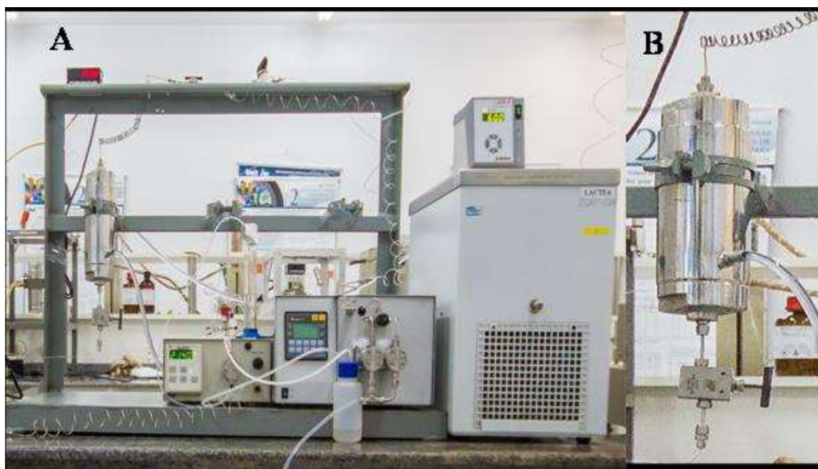
Figura 11: A – Unidade de extração com banho termostático, bombas de fluxo positivo e extrator. B - Extrator encamisado e válvula micrométrica.
