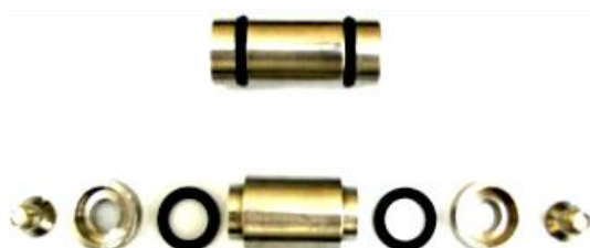
Figura 13- Imagem ilustrativa do pistão utilizado para pressurizar a célula de equilíbrio (Adaptado em CANZIANI, 2008).
