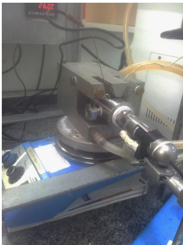
Figura 11 - Imagem ilustrativa da célula de equilíbrio em operação com a câmera microscópica acoplada.
