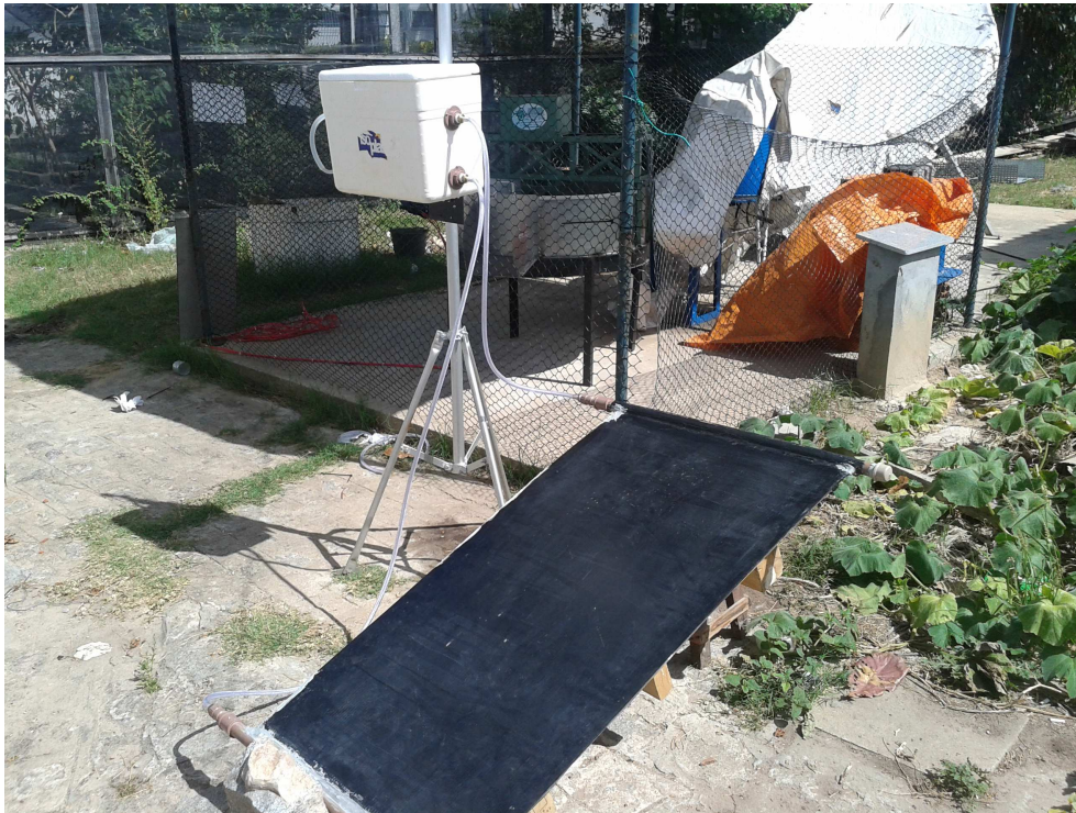
Figura 8 – Montagem do termossifão e reservatório de água
