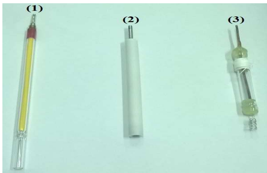
Figura 10 - Eletrodos utilizados: (1) Eletrodo de referência (H 2 ), (2) Eletrodo de trabalho (carbono vítreo) e (3) Contra eletrodo (fio de Pt).
