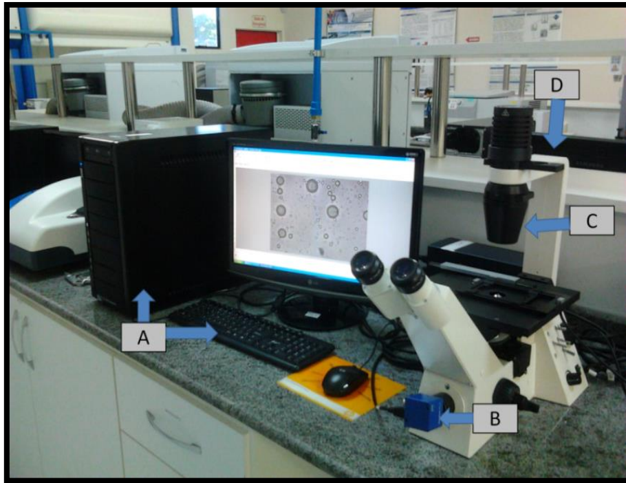
Figura 32: Vista geral do microscópio óptico invertido utilizado no presente trabalho. A) microcomputador, B) câmera CCD, C) fonte de luz e D) microscópio óptico invertido.
