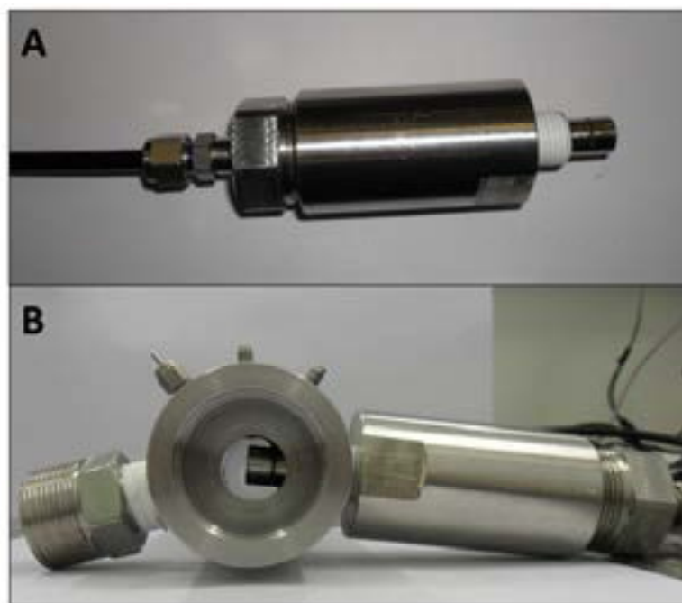
Figura 24: Imagens da sonda NIR (A) acoplada ao sistema de vedação e (B) conectada na célula de equilíbrio com caminho ótico no interior.
