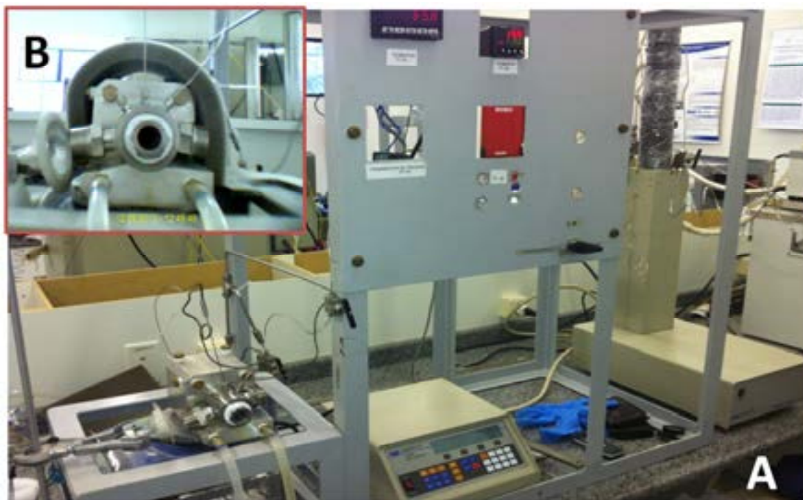
Figura 8: (A) Visão geral do aparato experimental e (B) visão frontal da célula de equilíbrio.
