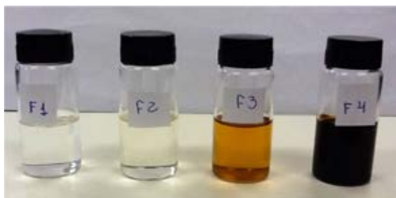
Figura 3: Imagem das quatro frações obtidas por destilação da amostra de petróleo.
