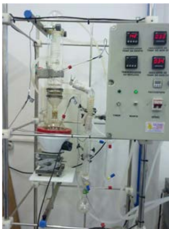
Figura 2: Imagem da coluna de destilação utilizada para obter as frações de petróleo.
