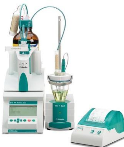
Figura 10: Titulador potenciométrico Titrino plus 870 Metrohm.
