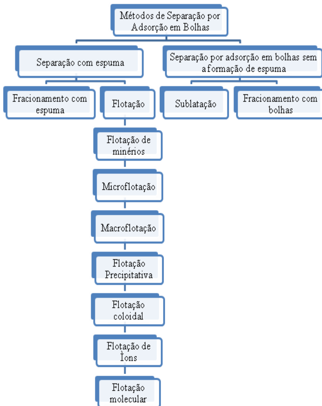
Figura 2.11: Esquema da classificação dos métodos de separação envolvendo o fenômeno de adsorção em bolhas
