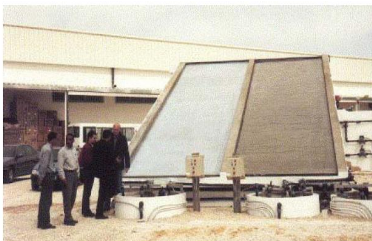
Figura 18 – Planta piloto de uma indústria têxtil na Tunísia composta por dois reatores tipo placa plana. Fonte: BAHNEMANN, (2004)
