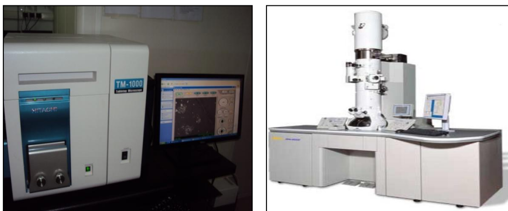
Figura 36 - (a) MEV Microscópio TM-1000 (Hitachi) e (b) MET Microscópio JEM-2100F (Jeol) (ICP-CSIC - Espanha)
