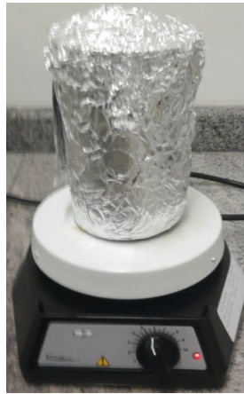
Figura 18: Solução de 200g de heptano e 5 g de petróleo em agitação por 4 horas.
