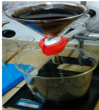
Figura 19: Solução de heptano e petróleo sendo filtrada no filtro de papel Whatman.
