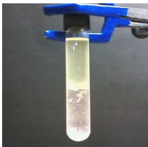
Figura 4.6: Tubocontendo as fases separadas durante o processo de lavagem, ésteres e glicerol (fase amarela) e subprodutos (fase rosa).
