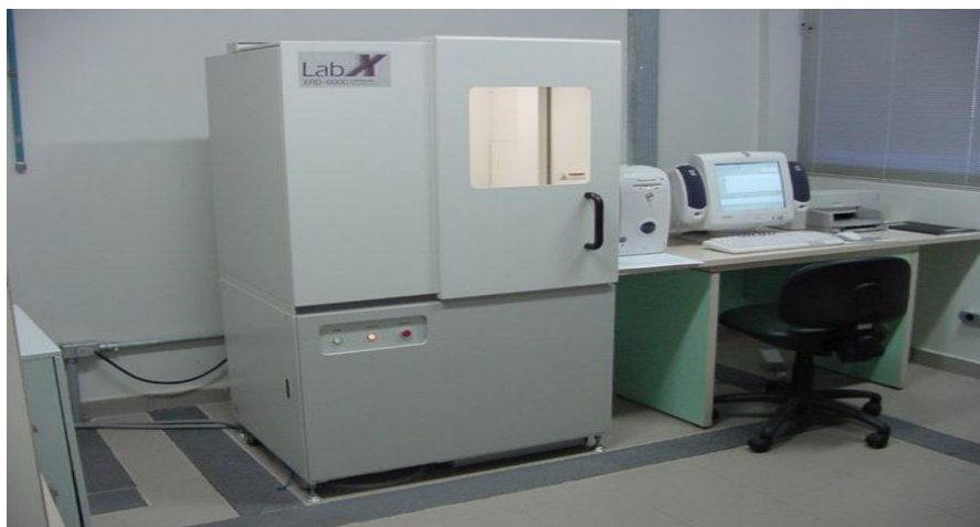
Figura 4.4: Difratorômetro XRD-6000 da marca Shimadzu em Natal/RN.
