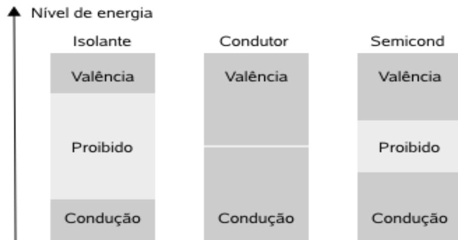
Figura 4: Nível de energia dos materiais Isolantes, condutor e semicondutor (BROPHY, 1977)
