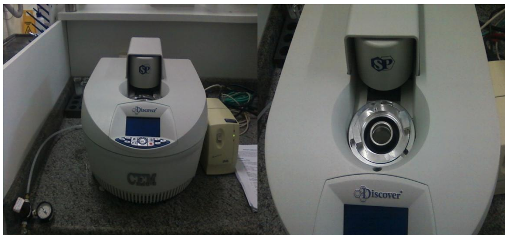
Figura 14: Micro-ondas CEM, modelo Discover com detalhes da cavidade única.
