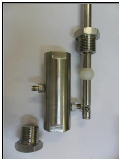
Figura 12 – Célula de fluxo da sonda NIR para alta pressão.
