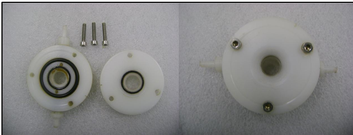
Figura 8 – Detalhes da câmara de fluxo laminar utilizada para as análises de DTG via microscopia ótica a baixa pressão.
