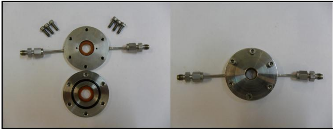
Figura 10 – Câmara de fluxo para as análises de DTG via MO no sistema pressurizado.
