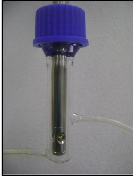
Figura 9 – Célula de fluxo da sonda NIR para baixa pressão.
