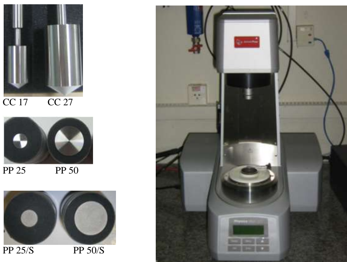
Figura 13: Reômetro Physica MCR 301 da Anton Paar e geometrias disponíveis: CC (cilindro coaxial), PP (placa-placa) e PP /S (placa-placa áspera). Os numerais que seguem os prefixos indicam o diâmetro (mm) de cada geometria.
