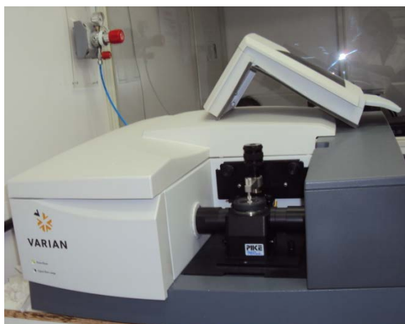
Figura 14: Aparelho de Espectrofotômetro no infravermelho médio FTIR da marca VARIAN 660-IR.
