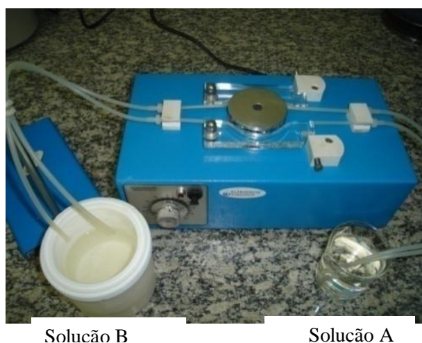
Figura 9. Esquema de síntese da hidrotalcita por coprecipitação.
