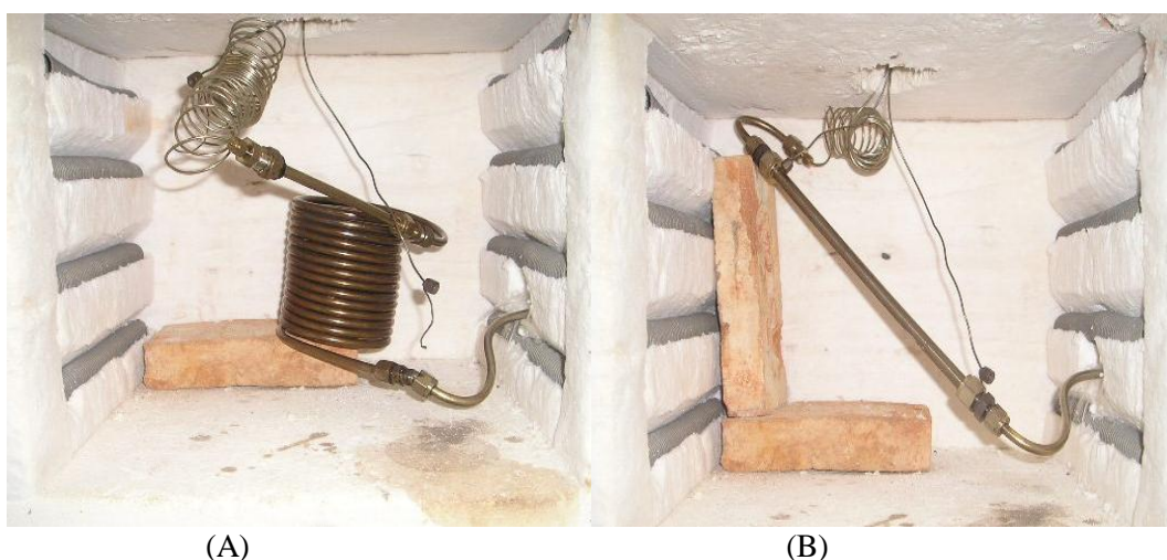
Figura 11: Vista interna do forno de aquecimento com diferentes geometrias de reatores: (A) reator não-catalítico em espiral com diâmetro externo de 1/4 de polegada e volume de 30 mL acoplado a um reator catalítico com volume de 3 mL. (B) reator catalítico com diâmetro externo de 3/8 de polegadas e volume de aproximadamente 15 mL
