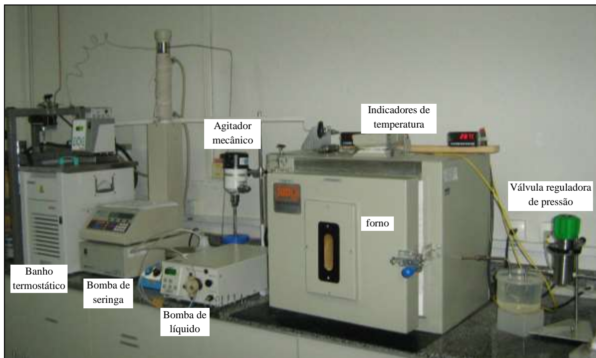
Figura 24: Unidade experimental montada para o estudo da transesterificação de óleos vegetais em meio contínuo supercrítico com adição de propano como cossolvente.
