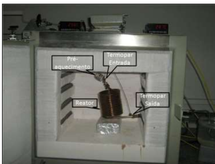
Figura 23: Detalhe do reator tubular inserido no interior do forno de aquecimento com conexões para os termopares e zona de pré-aquecimento.
