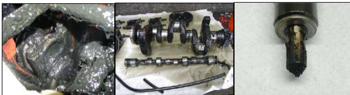
Figura 9: Acumulo de carbono no motor e entupimento do bico injetor provocado pelo uso de óleos vegetais não reagidos em motores de combustão interna – INNOCENTINI (2007).
