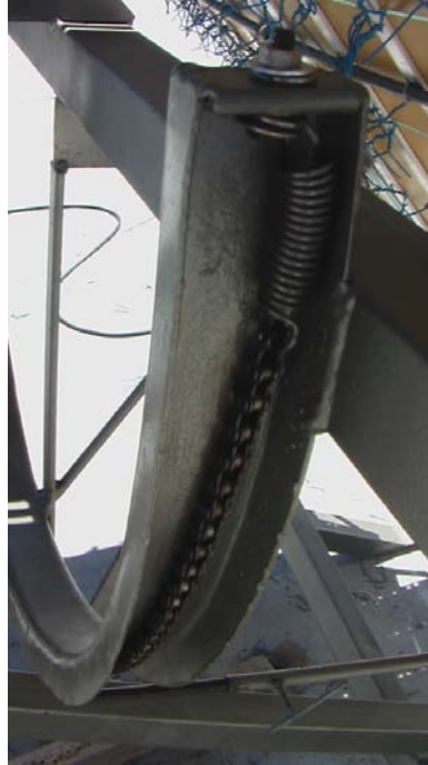
Figura 3.115. Corrente acoplada em R3 do suporte de rotação do concentrador solar.
