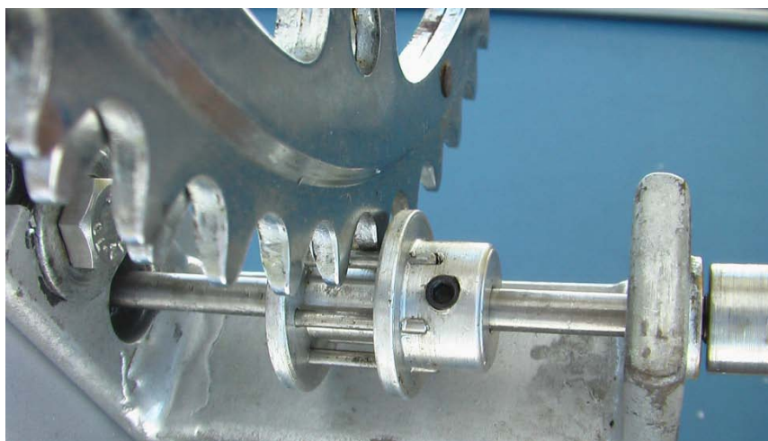
Figura 3.103. Encaixe da roda 92T do segundo eixo com a engrenagem 6T do primeiro eixo.
