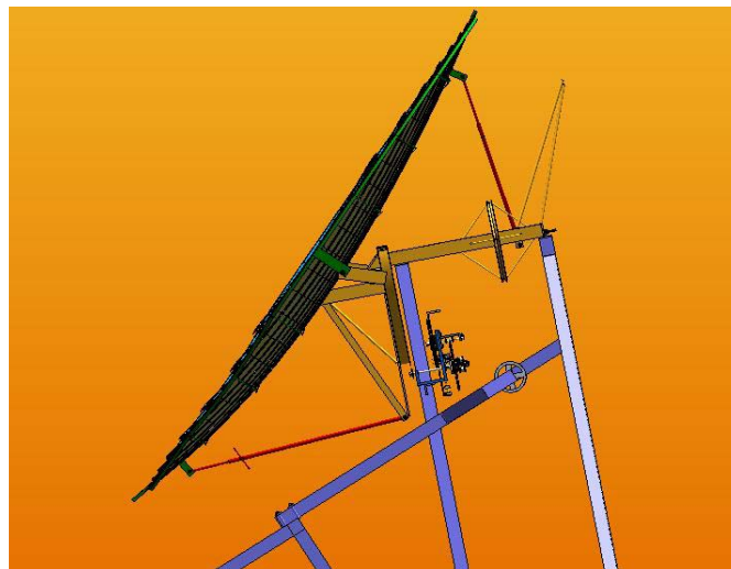
Figura 3.84. Sistema de Pêndulo encaixado na base do concentrador solar projetado em SolidWorks®.
