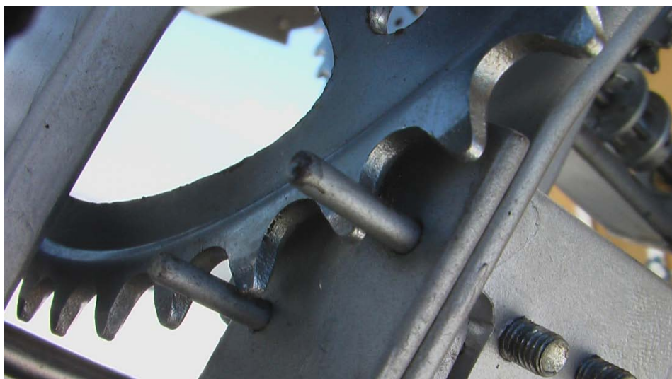
Figura 3.114. Encaixe dos pinos do pêndulo com a roda dentada do primeiro eixo.
