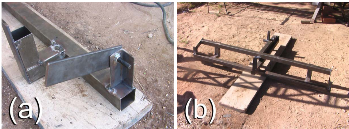
Figura 3.19. (a) imagem de R6 presa no gabarito do suporte de rotação com parafuso pela peça RI 5; (b) fotografia retratada após estarem presas no gabarito do suporte de rotação as peças R6 e R8 e encaixadas as peças R1(após preparo) e R2.
