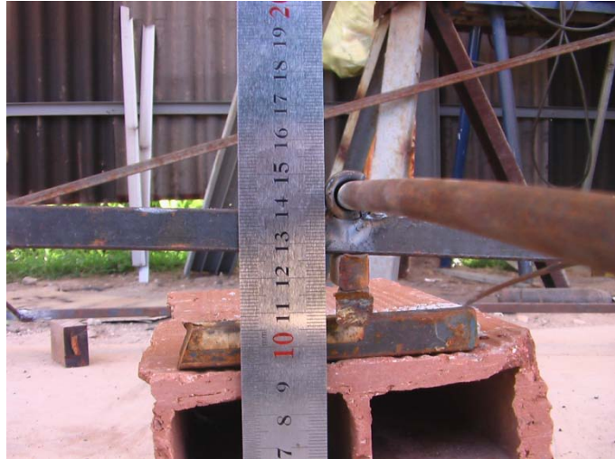
Figura 3.58. Medição da altura entre o ponto central de CB4 e a face frontal do arco. 139 mm.
