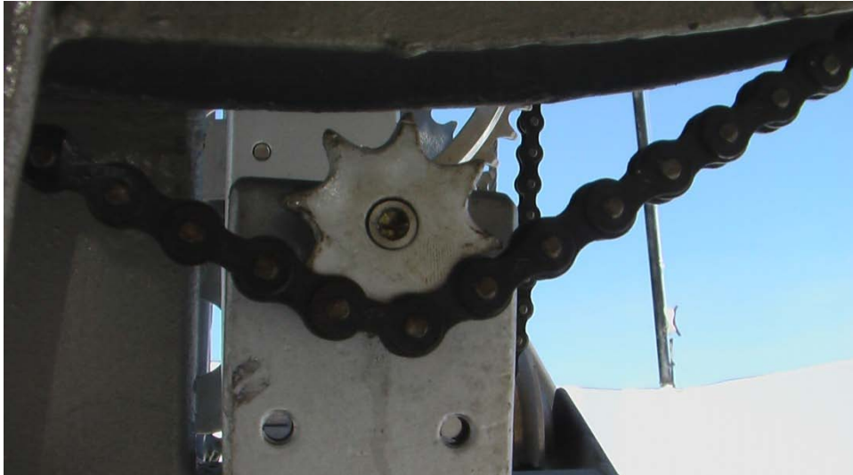
Figura 3.117. Roda dentada de 8T na corrente do concentrador solar.
