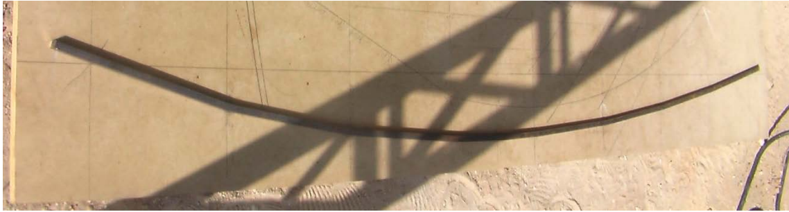
Figura 3.36. Barra central (sem as peças FC2 e FC3) sobre o gabarito na madeira.
