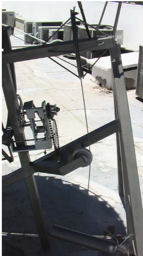
Figura 3.118. Contrapeso acoplado ao suporte de rotação
