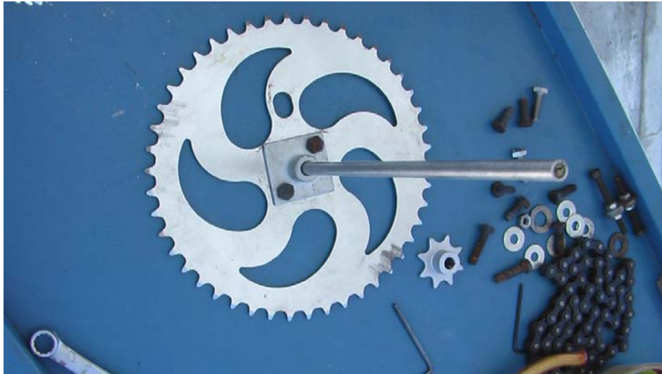
Figura 3.108. Fixação da roda 46T no terceiro eixo.
