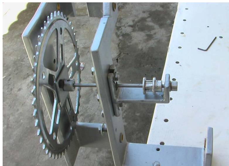
Figura 3.97. Primeiro eixo montado sobre o suporte principal.
