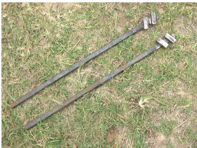
Figura 3.32. Par de chaves para dobra da barra quadrada de \frac{1}{2} '
