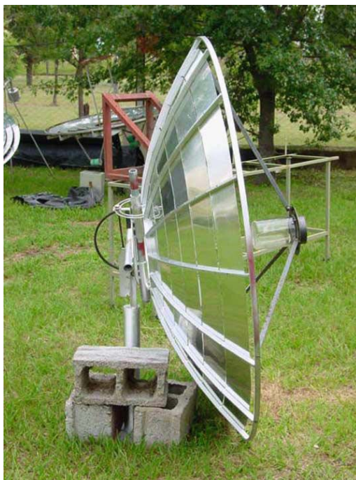
Figura 2.5. Concentrador Fresnel construído por Franco et al. (2004)
