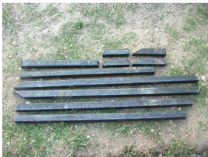
Figura 3.24. Peças utilizadas na construção da base do concentrador solar
