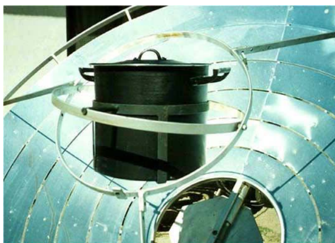
Figura 2.7. Concentrador com sistema de cardam. (FRANCO et al. , 2004).
