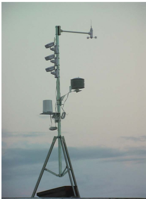
Figura 3.8. Miniestação Meteorológica montada no suporte.
