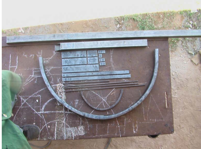
Figura 3.18. Peças utilizadas para a construção do suporte de rotação.
