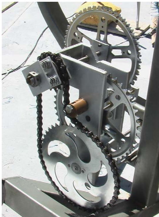
Figura 3.116. Sistema de pêndulo de três eixos acoplado ao concentrador solar de foco fixo.
